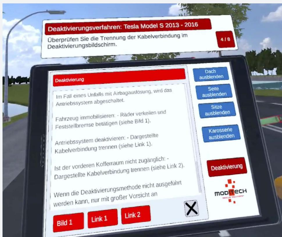
Jetzt wird ein Bildschirm mit Informationen über die Notfall-Kabelentriegelung angezeigt.
