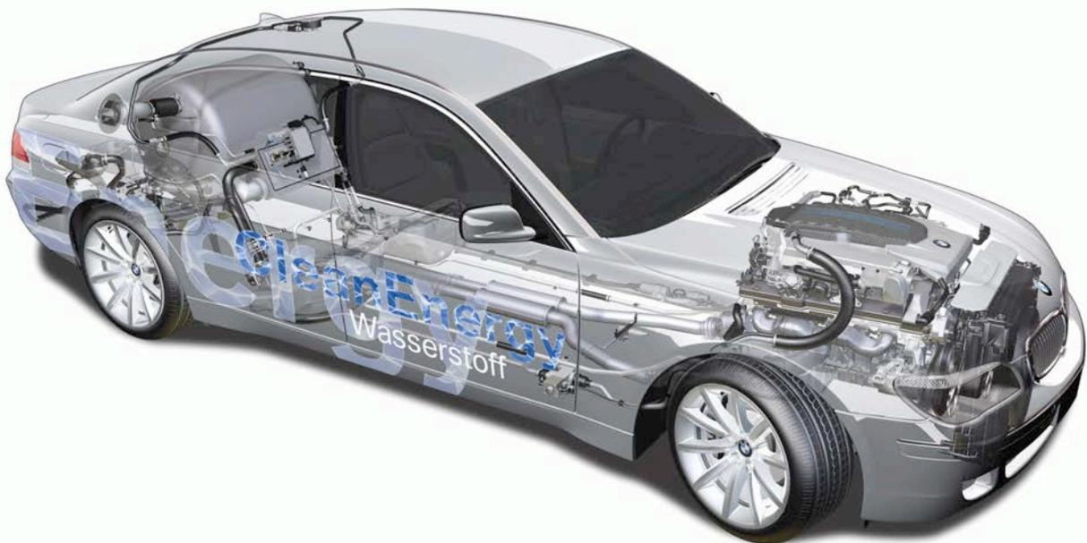
**Abbildung 18: BMW Hydrogen7 Versuchsfahrzeug mit Wasserstoffantrieb. Bei diesem Fahrzeug wird der Wasserstoff bei -253 °C flüssig gespeichert und in einem Verbrennungsmotor verbrannt (Grafik: BMW).**
