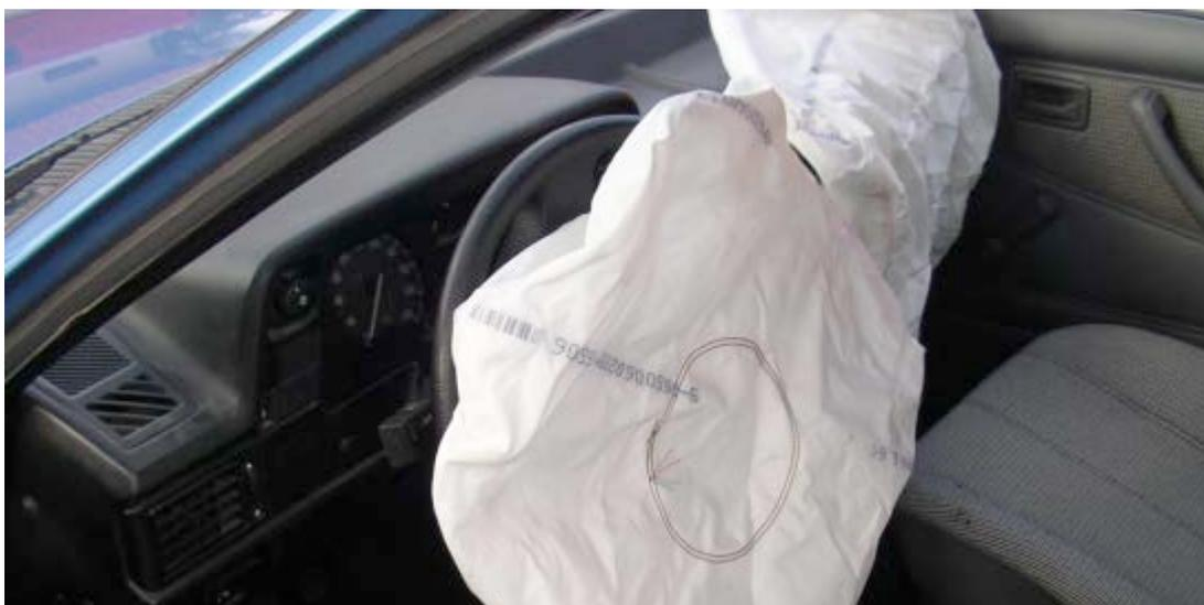
Abbildung 37: Nachträgliche angebrachte Airbags für Fahrer- und Beifahrer
