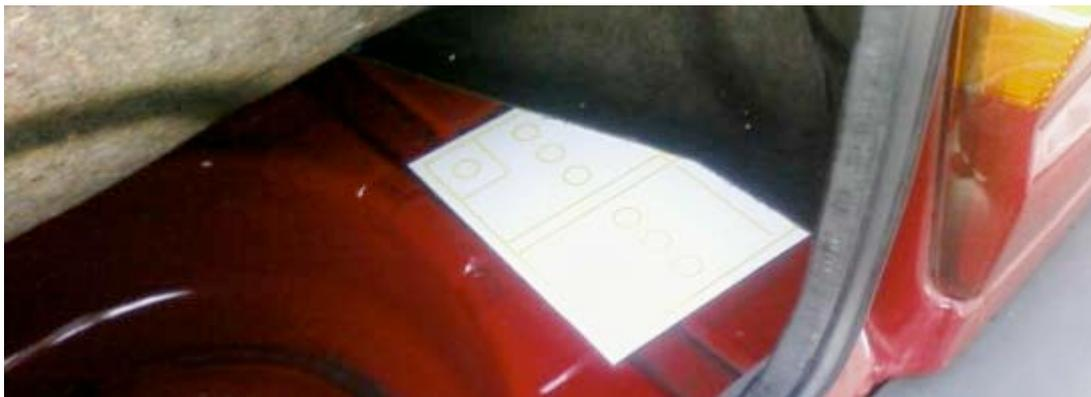
Abbildung 38: Batterie-Dummy im Kofferraum des Fahrzeugs
