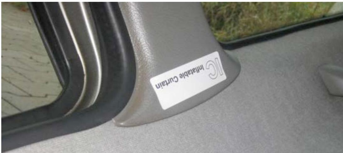
Abbildung 36: Nachträgliche angebrachte Kennzeichnung eines Kopfairbags
