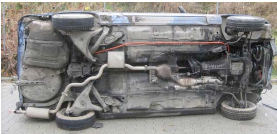
Abbildung 39: Nachträglich angebrachtes Hochvoltkabel am Fahrzeugboden
