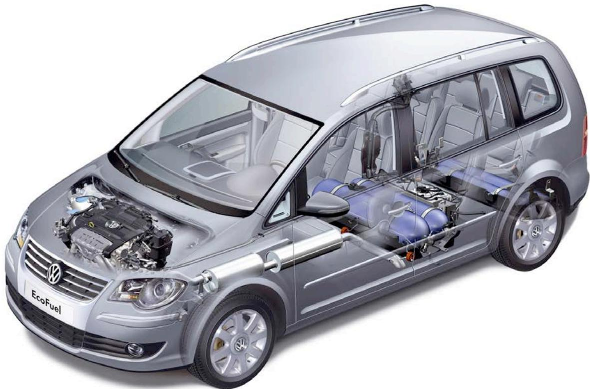
**Abbildung 3: Erdgasfahrzeug Volkswagen Touran Ecofuel (Quelle: Volkswagen AG)**
