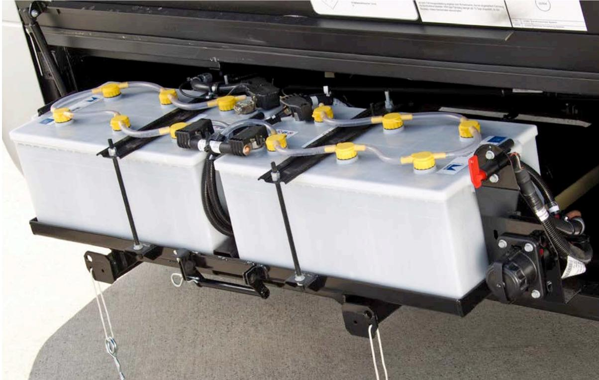
**Abbildung 25:** Bei Bussen sind in der Regel zwei 12 Volt Batterien in Reihe geschaltet. Sie befinden sich häufig in von außen zugänglichen Batteriefächern. Oftmals ist auch ein Batterie Hauptschalter vorhanden. (Foto: Evobus GmbH)
