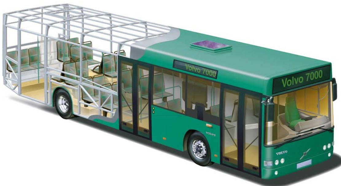
Abbildung 18: Gerippebauweise bei einem Stadtbus. (Grafik: Volvo Bus)
