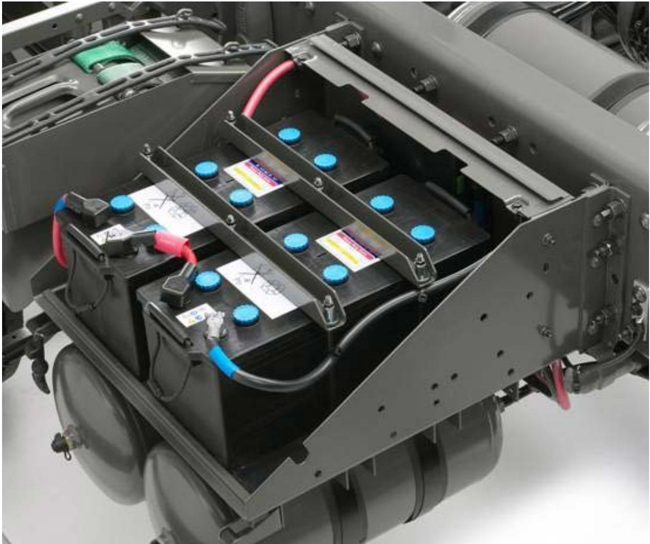
**Abbildung 14:** Bei LKW sind in der Regel zwei 12 Volt Batterien in Reihe geschaltet um das elektrische System mit Spannung zu versorgen. (Foto: Volvo Trucks)
