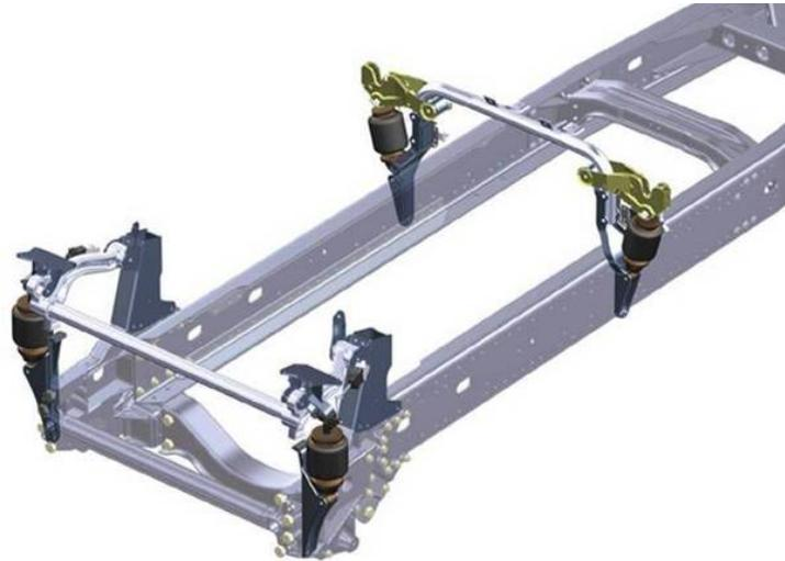
**Abbildung 8: Fahrerhauslagerung bei einem LKW. Das Fahrerhaus ist an vier Punkten auf dem Fahrgestellrahmen gelagert. In diesem Fall sorgt eine Luftfederung für den notwendigen Komfort. (Grafik: MAN Nutzfahrzeuge)**
