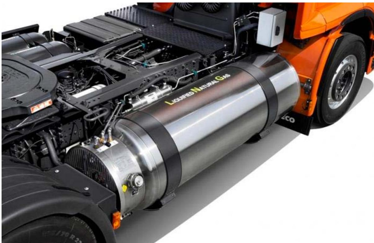
**Abbildung 28:** Verflüssigtes Erdgas (LNG) wird in speziellen Tanks (sog. Kryogentanks) bei  $-162\text{ °C}$  mitgeführt. Das gezeigt Fahrzeug verfügt über eine Kombination aus CNG und LNG Antrieb. (Grafik: Iveco)
