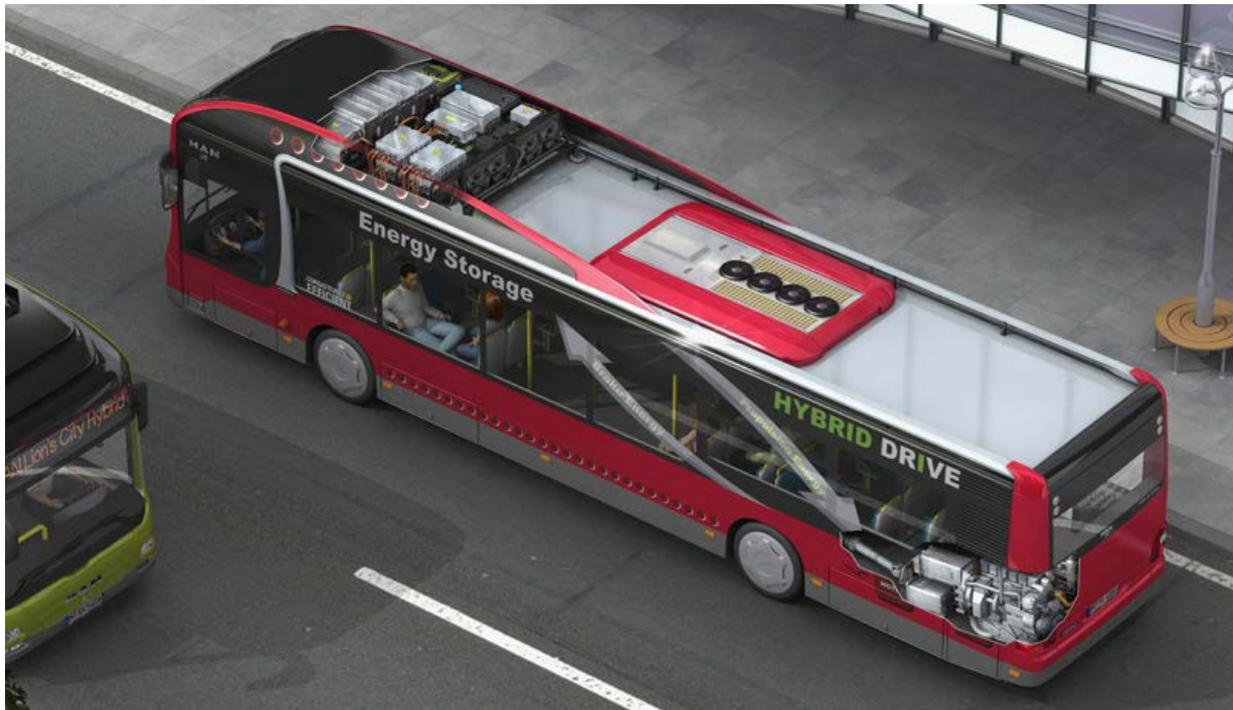
**Abbildung 31: MAN Lion's City Hybrid. Der Stadtbuss wird von zwei Elektromotoren angetrieben. Den Strom liefert entweder ein Energiespeicher mit Ultrakondensatoren, der auf dem Fahrzeugdach verbaut ist, oder ein Generator, der von einem Dieselmotor angetrieben wird. (Grafik: MAN Nutzfahrzeuge)**
