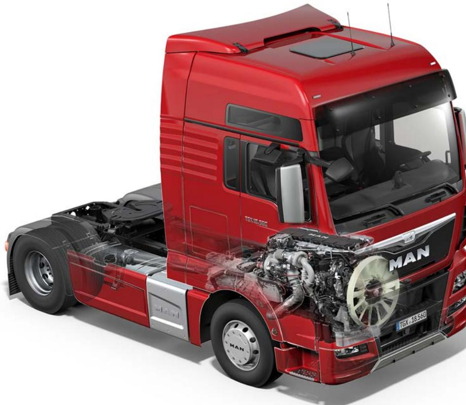
**Abbildung 9: Fernverkehrs-LKW. Der Dieselmotor ist unter dem Fahrerhaus im Fahrgestellrahmen montiert. Das Fahrerhaus kann deshalb für Wartungszwecke nach vorne gekippt werden. (Grafik: MAN Nutzfahrzeuge)**
