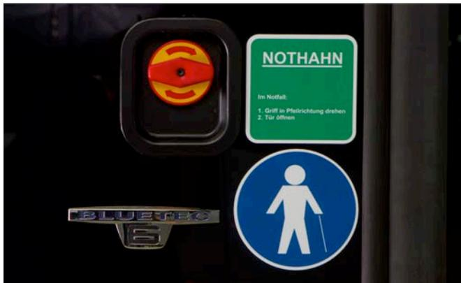
Abbildung 21: Notbetätigung außen an der Tür eines Stadtbusses. (Foto: Evobus GmbH)
