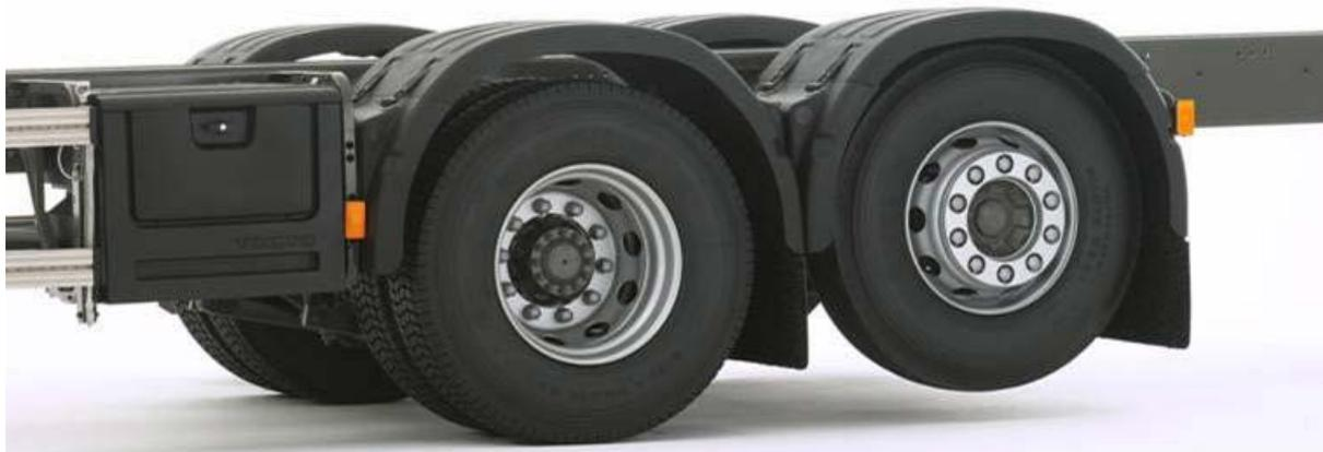
**Abbildung 5:** Angehobene Liftachse. (Foto: Volvo Trucks)
