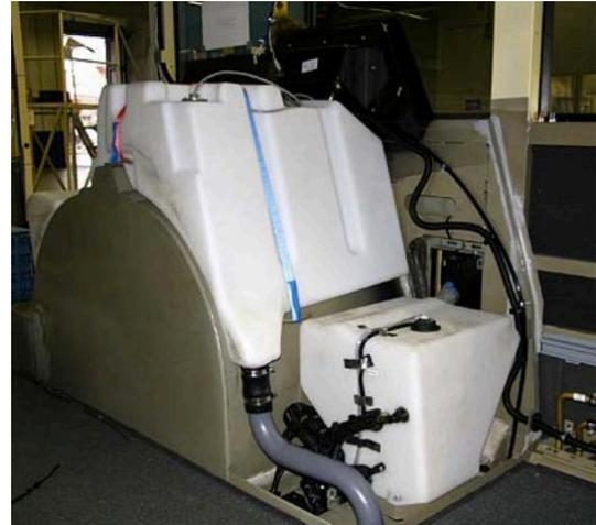
**Abbildung 20: In die vorderen Fahrgastsitze integrierter Tank bei einem Stadtbus. (Foto: Evobus GmbH)**
