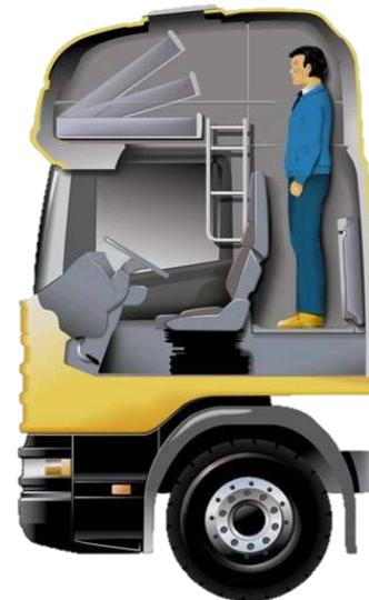
**Abbildung 11:** LKW verfügen häufig über Ruheliegen für die Insassen. (Grafik: Scania)
