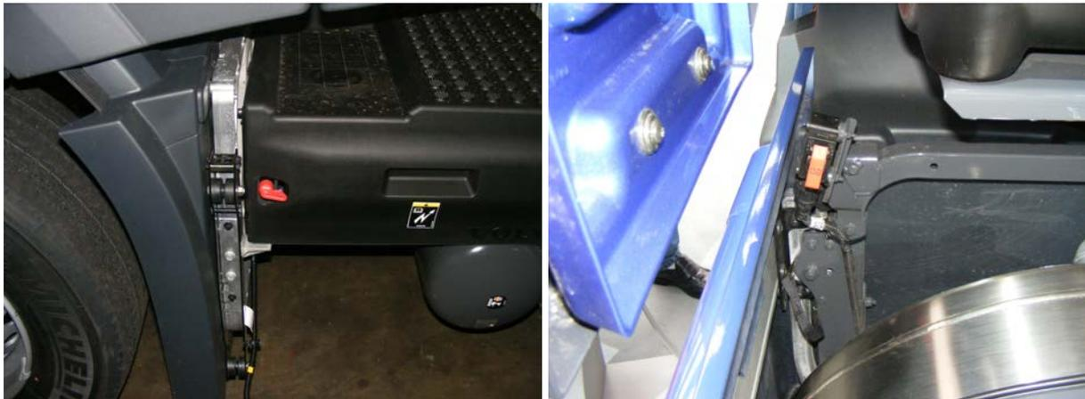
**Abbildung 15: Unterschiedliche Batterie Hauptschalter bei LKW**
