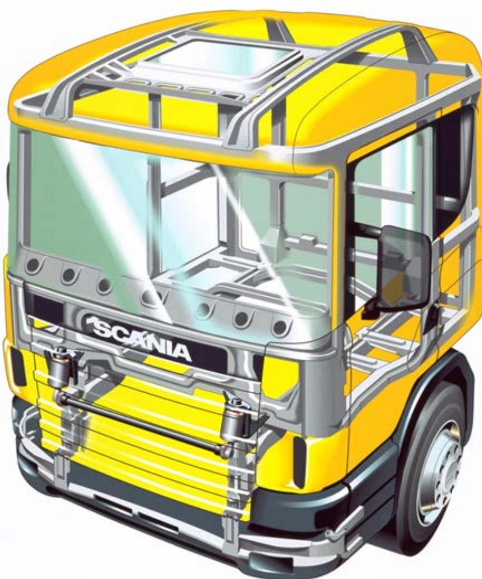
**Abbildung 6: Konstruktion eines LKW-Fahrerhauses. (Grafik: Scania)**
