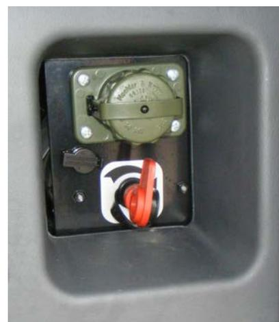
**Abbildung 26:** Batterie Hauptschalter bei einem Reisebus.
