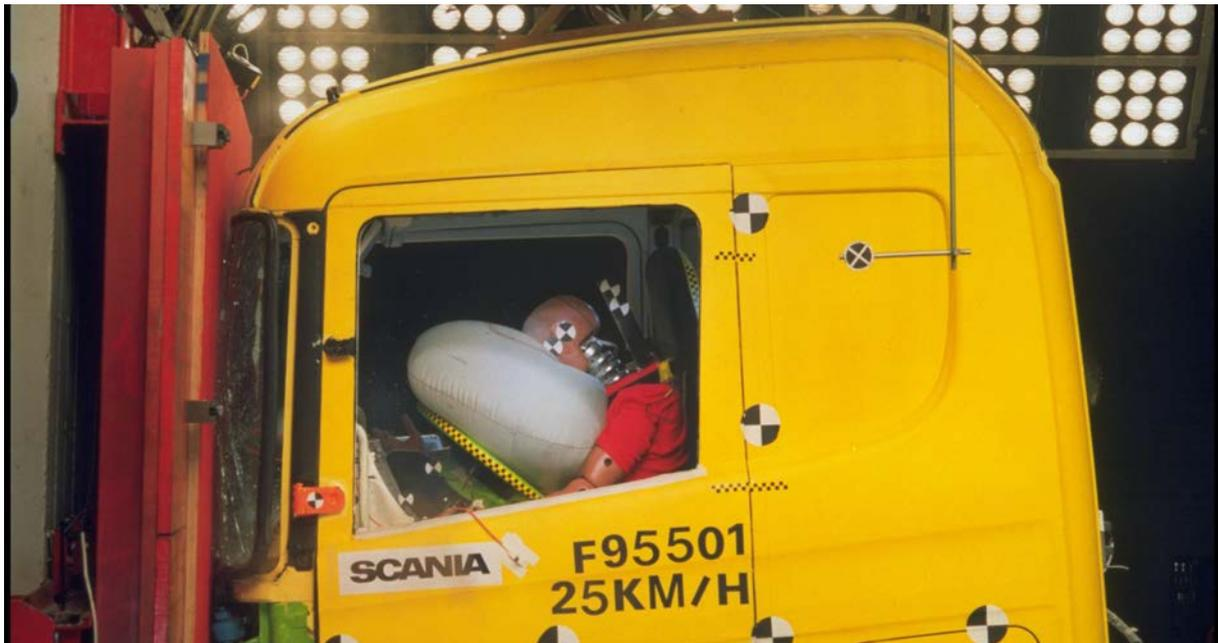
**Abbildung 17:** Auch in LKW gilt, dass der Sicherheitsgurt der Lebensretter Nr. 1 ist! Die Schutzwirkung des Sicherheitsgurtes kann ggf. durch Gurtstraffer und einen Fahrerairbag ergänzt werden. (Foto: Scania)
