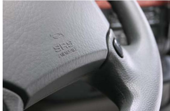
**Abbildung 16: Fahrerairbag mit entsprechender Beschriftung bei einem LKW (Foto: Volvo Trucks)**
