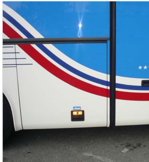
**Abbildung 23:** Bei diesem Bus befindet sich der Fahrerruheraum vor dem hinteren Einstieg. Im Regelfall ist er von außen und innen zugänglich. (Foto: Rüdiger Knoll)
