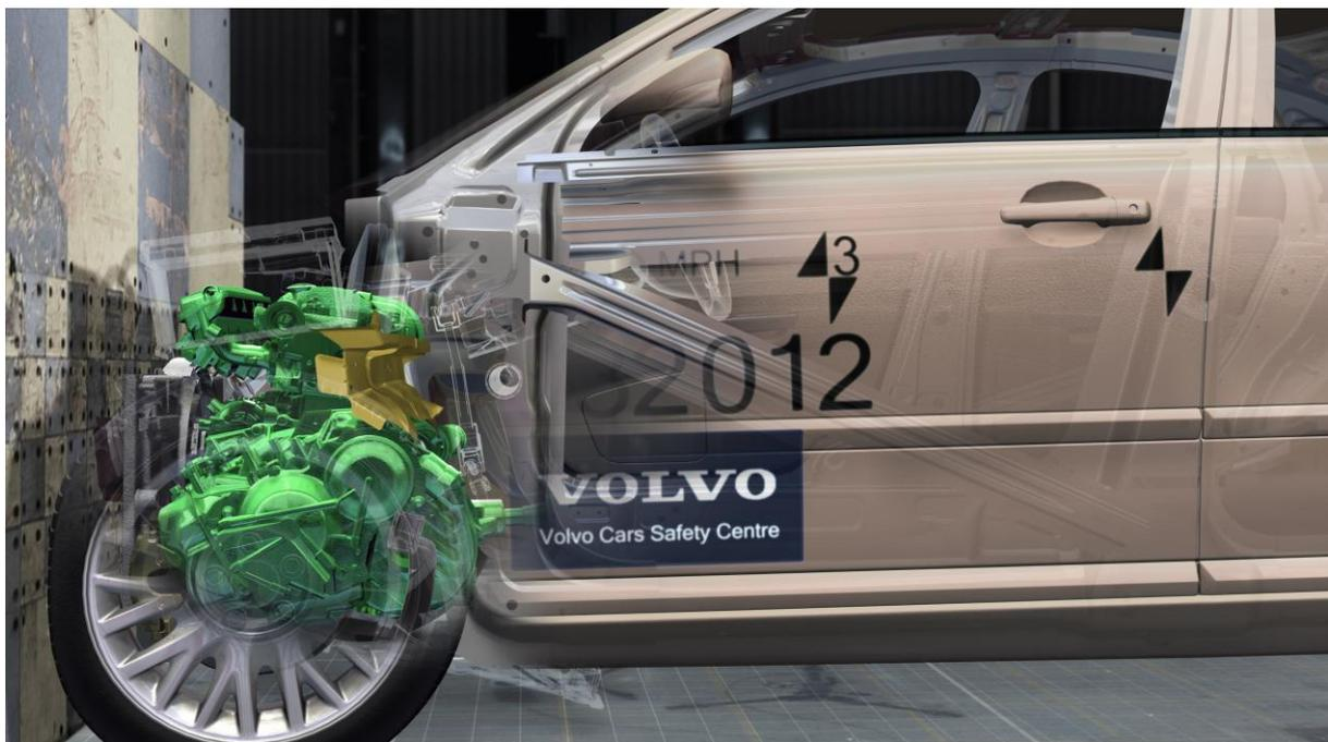
**Abbildung 4: Ein Querträger der beide A-Säulen verbindet hindert den Motor bei diesem Fahrzeug daran in die Fahrgastzelle einzudringen und den Überlebensraum einzuschränken. (Grafik: Volvo)**
