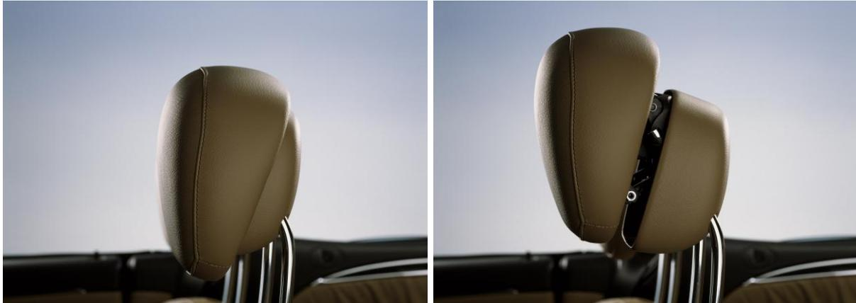
**Abbildung 17: Daimlers Neck-Pro Schleudertrauma-Schutzsystem reduziert den Abstand zwischen dem Kopf des Insassen und der Kopfstütze um eine Überdehnung der Halswirbelsäule zu verhindern. (Fotos: Daimler)**
