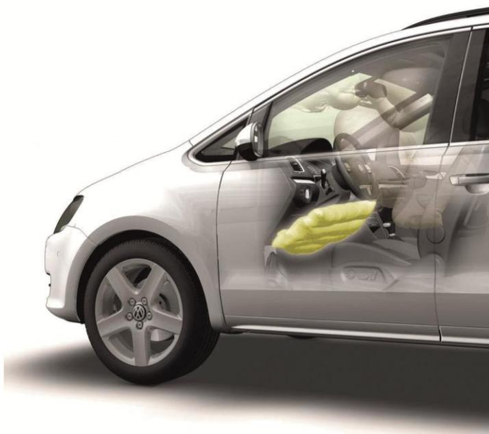
**Abbildung 9:** Fahrerseitiger Knieairbag bei einem Volkswagen Sharan. Der Knieairbag entfaltet sich aus dem unteren Bereich des Armaturenbretts. (Grafik: Volkswagen)
