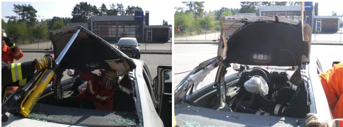
**Abbildung 35:** Der hintere Teil der Dachfläche konnte in diesem Fall mit einem Hydraulikzylinder angehoben bzw. nach vorne gebogen werden. Hierzu kann es im ersten Schritt erforderlich sein Entlastungsschnitte links und rechts in die hintere Dachkante zu setzen um Startpunkte für das Reißen zu definieren. In diesem Fall ist die Dachfläche an den Schweißpunkten an der Dachkante abgerissen.
