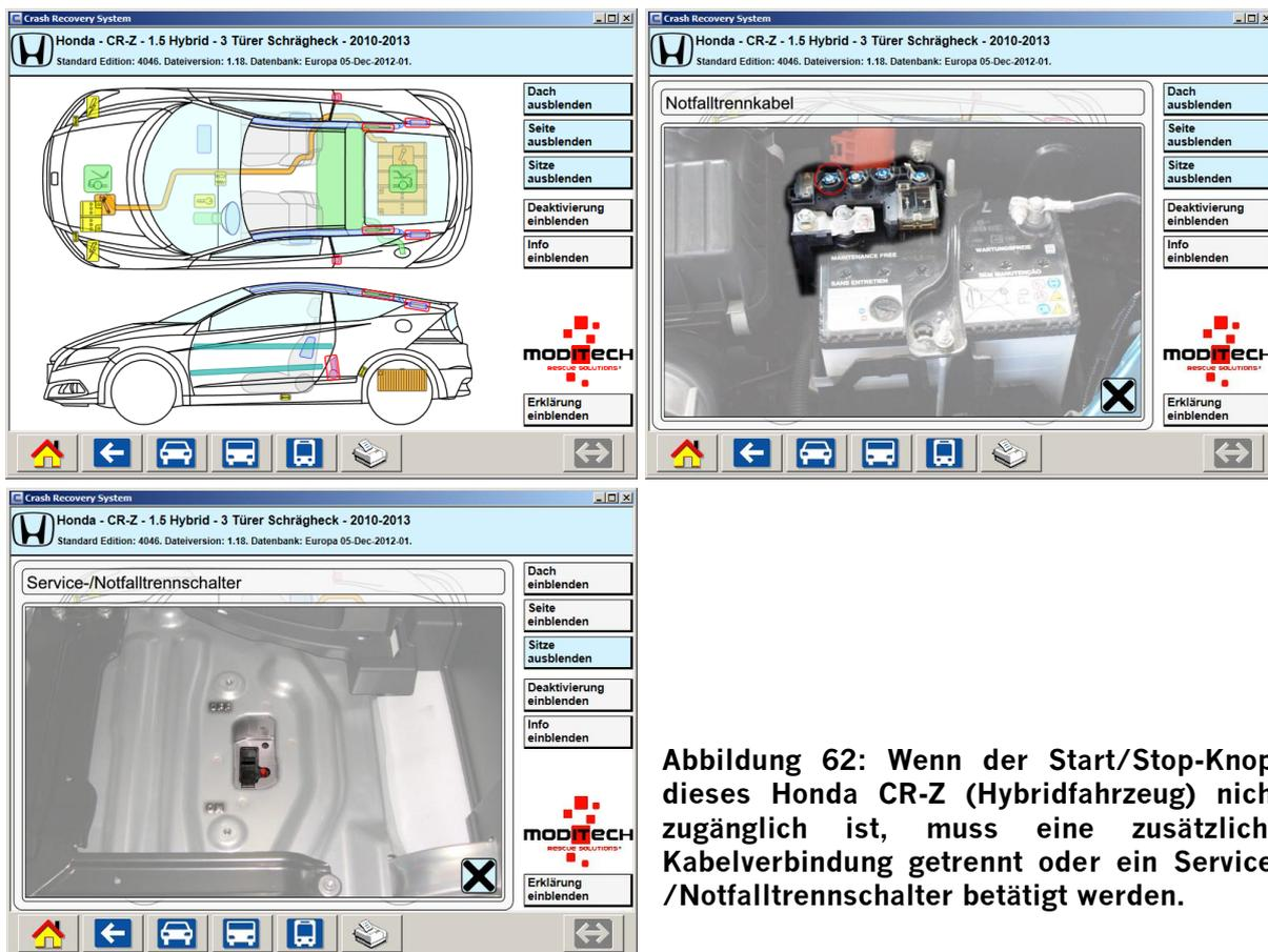
Abbildung 62: Wenn der Start/Stop-Knopf dieses Honda CR-Z (Hybridfahrzeug) nicht zugänglich ist, muss eine zusätzliche Kabelverbindung getrennt oder ein Service-/Notfalltrennschalter betätigt werden.
