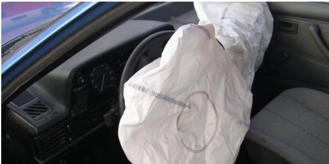
**Abbildung 67: Nachträgliche angebrachte Airbags für Fahrer- und Beifahrer**
