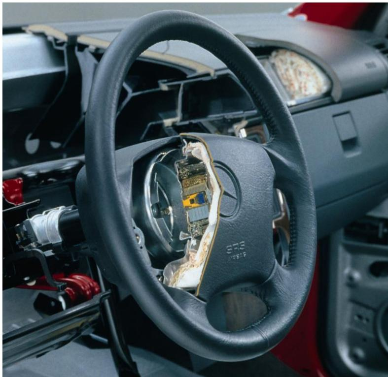
**Abbildung 41: Schnittmodell eines Fahrerairbags. Der pyrotechnische Gasgenerator ist in der Mitte des Lenkrades sichtbar. Bei Zündung brennt die pyrotechnische Treibladung ab und erzeugt eine große Menge Stickstoff um den Airbag zu füllen. Beim Entfalten reißt dieser die Abdeckung des Lenkrades auf. (Foto: Daimler)**
