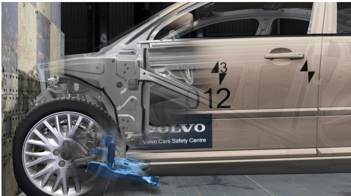
**Abbildung 5: Das Rad wird bei einem schweren Unfall zurückgeschoben und kann sich an der verstärkten A-Säule abstützen. Hierdurch wird der Fußraum geschützt. (Grafik: Volvo)**
