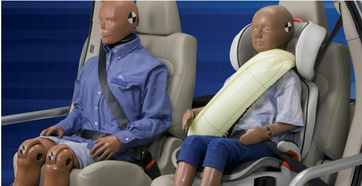
**Abbildung 11: Gurtairbag, hier gezeigt bei Insassen auf dem Rücksitz. Der Gurtairbag hilft dabei die Unfallenergie besser über den Körper der Insassen zu verteilen. (Foto: Ford)**
