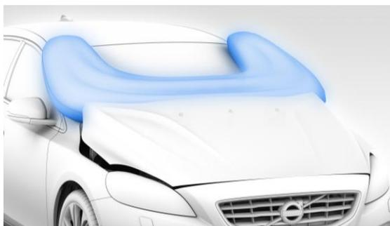
**Abbildung 22: Fußgänger-Airbag bei einem Volvo V40. Wenn eine Kollision mit einem Fußgänger erkannt wird werden die Scharniere der Motorhaube von zwei kleinen pyrotechnischen Ladungen freigegeben. Der Fußgänger-Airbag entfaltet sich anschließend und hebt die Haube ca. 10 cm an. Durch den Airbag wird die Verletzungsgefahr beim Anprall an harte Bauteile reduziert. (Grafik: Volvo)**
