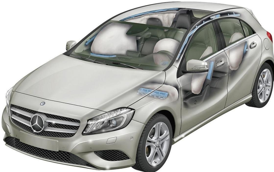
**Abbildung 42: Airbagausstattung einer Mercedes-Benz A-Klasse. Ein Fahrerairbag, Knieairbags für Fahrer- und Beifahrer, sitzseitig montierte Seitenairbags vorne und hinten sowie der durchgehende Kopfairbags sind auf der Grafik erkennbar. (Grafik: Daimler)**
