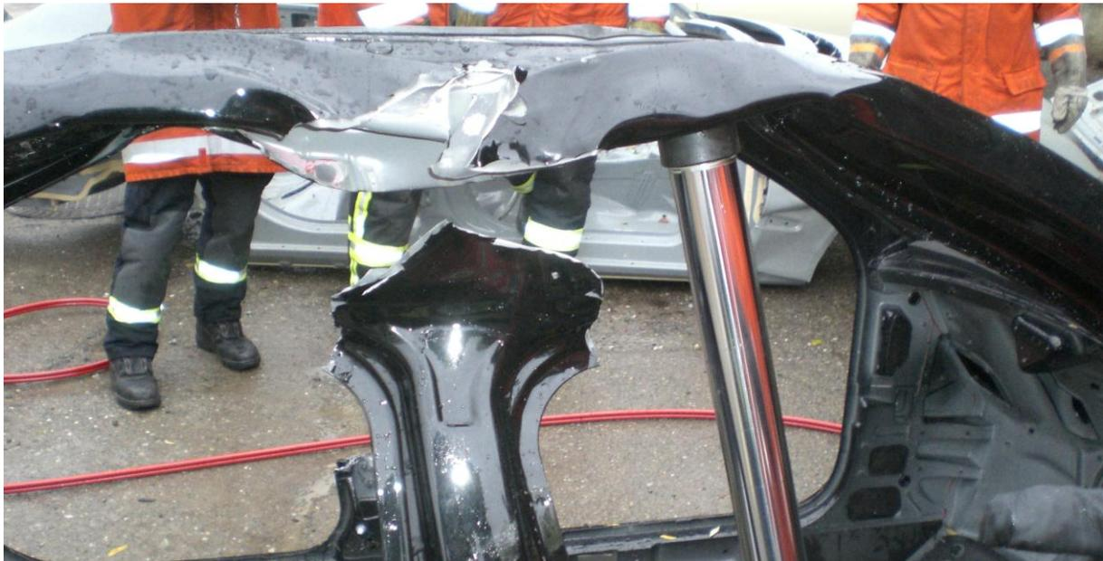
**Abbildung 32:** Die B-Säule dieser Mercedes-Benz S-Klasse wurde mit einem Hydraulikzylinder gerissen. Der Zylinder wurde zwischen Schweller und Dachkante angesetzt und dann ausgefahren. Das Dach konnte so komplett von der B-Säule abgerissen werden.
