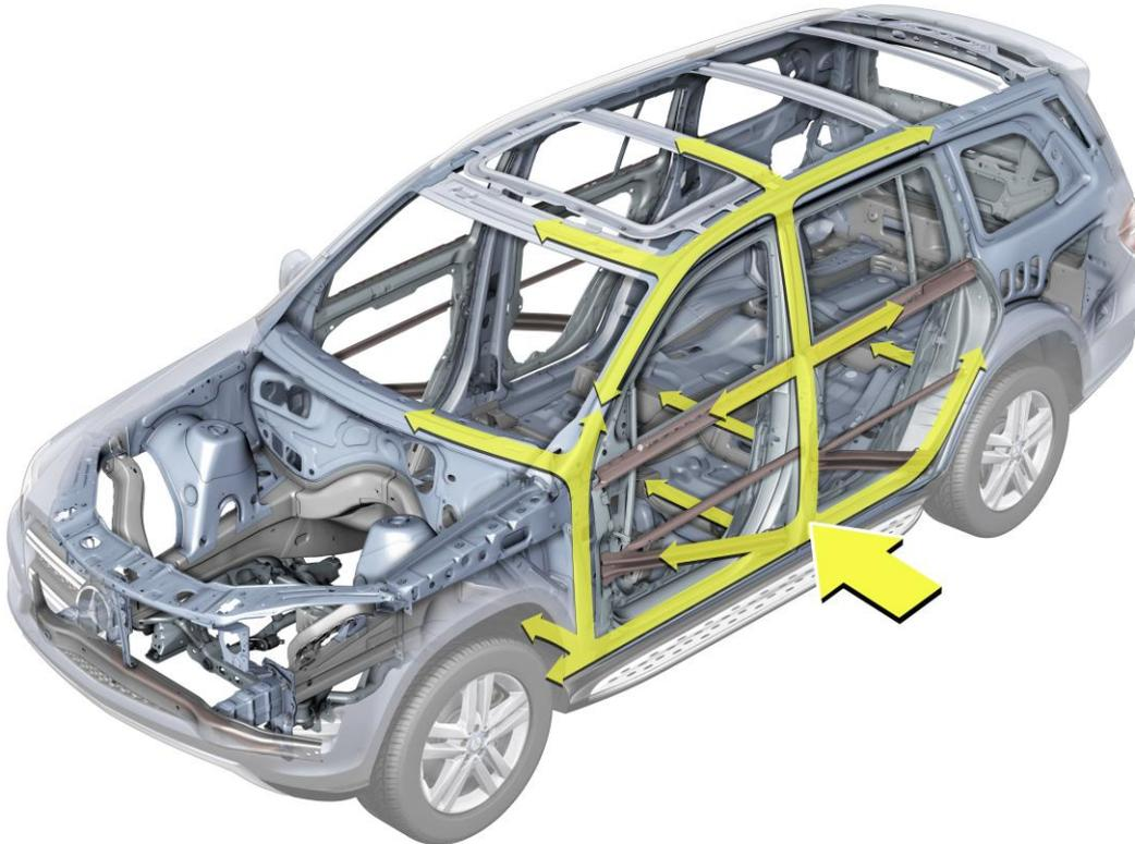
**Abbildung 12: Karosseriestruktur eines Mercedes-Benz GL. Die Pfeile zeigen die Lastpfade im Fall einer Seitenkollision. Anders als bei Frontalunfällen ist der Abstand zwischen Insassen und Seitenstruktur gering. Deshalb gibt es nicht viel Deformationszone (Knautschzone) zum Energieabbau. Deshalb versuchen die Fahrzeughersteller die Seitenstruktur so massiv zu verstärken, dass die Intrusion in die Fahrgastzelle möglichst gering ausfällt. (Grafik: Daimler)**
