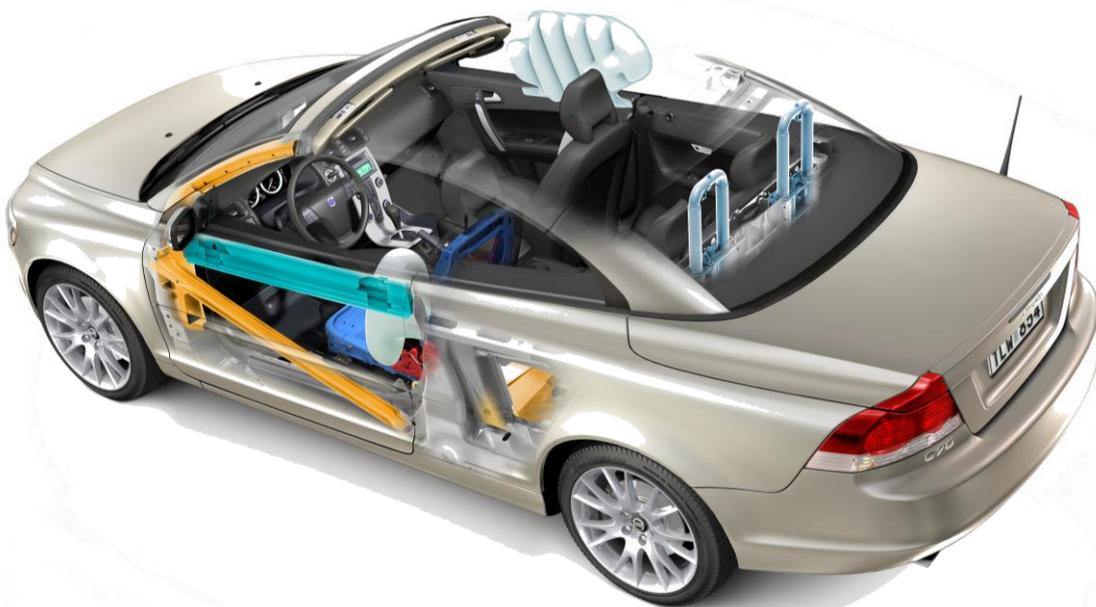
**Abbildung 20: Das Sicherheitssystem von Cabriolets kann einige Besonderheiten aufweisen. Die Abbildung zeigt einen türseitig montierten Kopfairbag, da ein Kopfairbag nur schwer im Dach untergebracht werden kann. Das Fahrzeug verfügt auch über einen automatische Überrollschutz hinter den Rücksitzen und eine verstärkte A-Säule. (Grafik: Volvo)**
