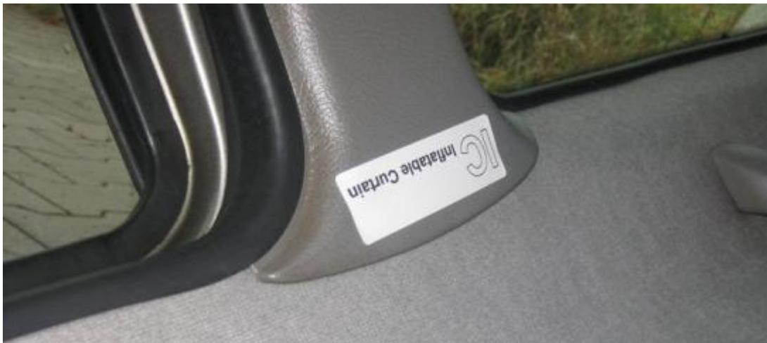
**Abbildung 66: Nachträgliche angebrachte Kennzeichnung eines Kopfairbags.**
