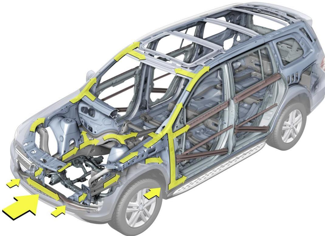
**Abbildung 3: Karosseriestruktur eines Mercedes-Benz GL-Class. Die Pfeile zeigen die Lastpfade im Falle einer Frontalkollision. Der vordere Bereich ist als Knautschzone ausgelegt und absorbiert Unfallenergie. Die Sicherheitsfahrpassagierzelle soll möglichst lange intakt bleiben. (Grafik: Daimler)**
