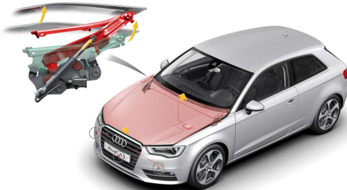
**Abbildung 21: Fußgängerschutzsystem, hier bei einem Audi A3. Sensoren im vorderen Stoßfänger erkennen eine Kollision mit einem Fußgänger und lösen zwei pyrotechnisch freigegebene Kolben aus, die den hinteren Bereich der Motorhaube anheben. Hierdurch wird der Freiraum zwischen Haube und Motorteilen vergrößert. (Grafik: Audi)**
