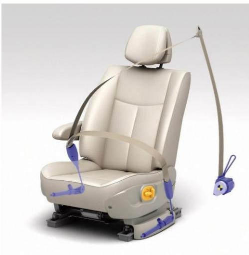
**Abbildung 43: Fahrersitz mit Sicherheitsgurt. Der Gurtstraffer kann entweder am Gurtaufroller, am Gurtschloss oder am Endbeschlag des Beckengurtes montiert sein. In diesem Fall gibt es zwei Gurtstraffer, einen am Gurtschloss, einen am Endbeschlag. (Grafik: Renault)**
