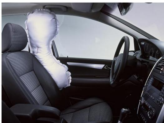
**Abbildung 14: Sitzseitig montierter Seitenairbag, der sich auch nach oben entfaltet und so auch den Kopfbereich des Insassen abdeckt. (Foto: Daimler)**
