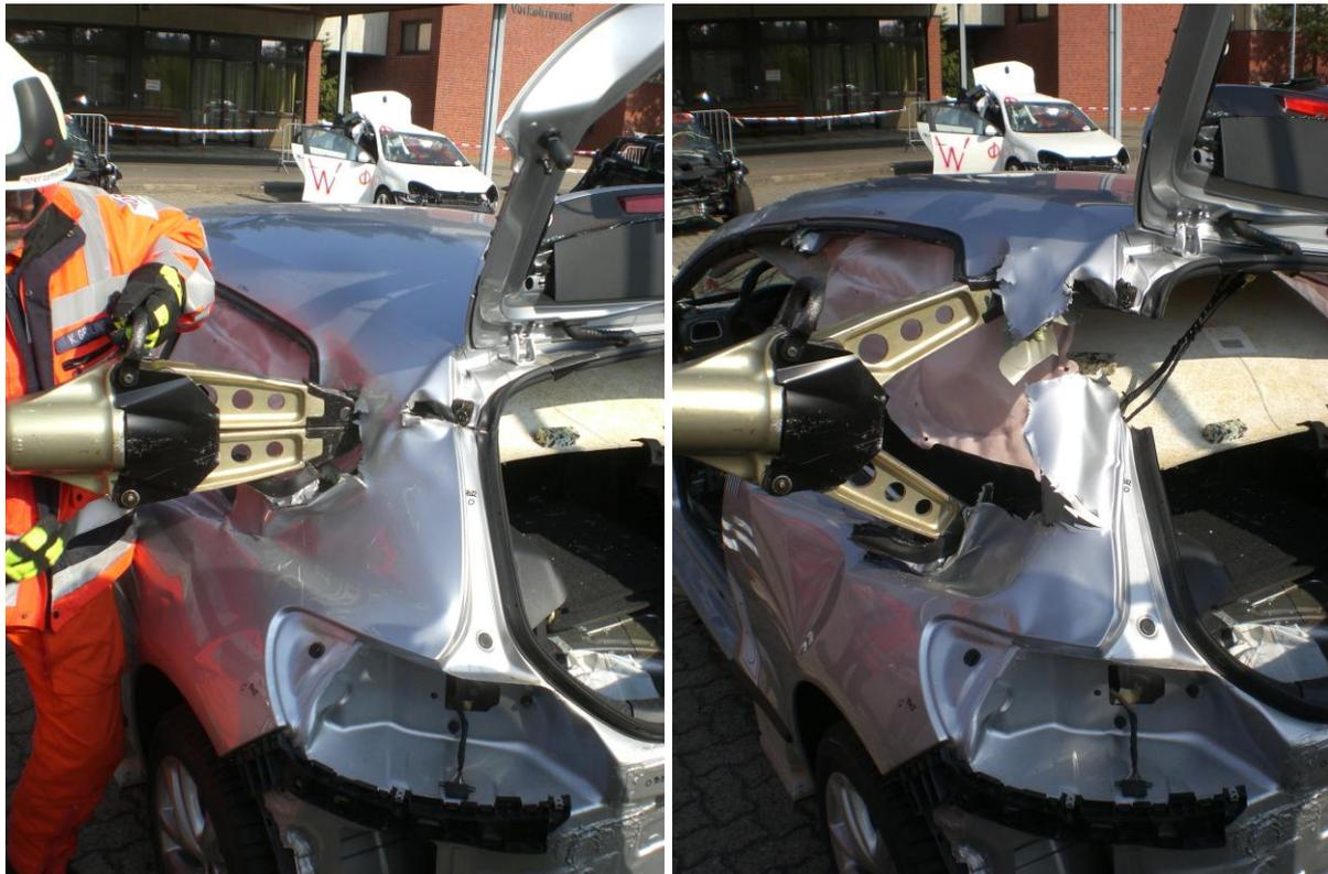
**Abbildung 34:** Der Spreizer wird bei diesem Volkswagen Scirocco zum Reißen der C-Säule eingesetzt. Zuerst hatte der Geräteführer erfolglos versucht die Säule mit Schnitten von links und rechts zu durchtrennen. Anstatt den verbleibenden (schwer zugänglichen) Teil der Säule zu schneiden wurde dieser mit Hilfe des Spreizers durchgerissen.
