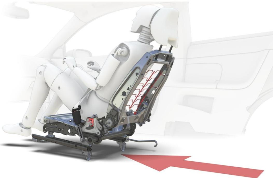
**Abbildung 18: Sitze von aktuellen Volvos sind mit WHIPS (Whiplash Protection System) ausgestattet. Bei diesem System ist die gesamte Sitzlehne darauf ausgelegt sich bei Heckkollisionen mit dem Insassen zu bewegen. Hierfür ist der Sitz mit einem Metallteil ausgestattet, dass sich bei einem Unfall verbiegt und so Energie absorbiert. (Grafik: Volvo).**
