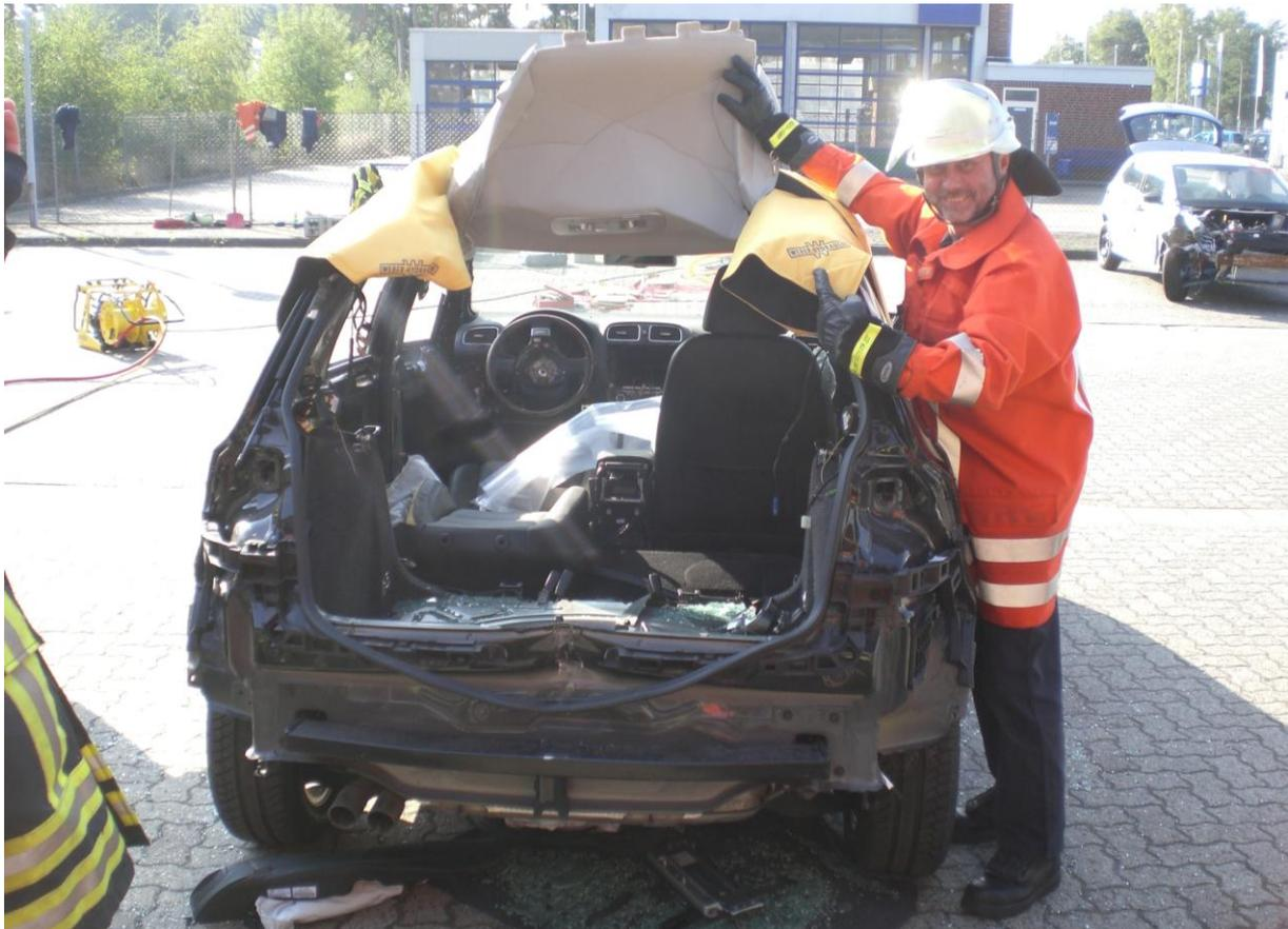
**Abbildung 38:** Das Blech des Daches dieses Volkswagen Golfs wurde auf beiden Seiten mit einer Säbelsäge durchtrennt. Anschließend konnte es zusammen mit dem Dachhimmel nach vorne umgeklappt werden. Hierdurch ist genug Raum entstanden um den Patienten durch den Heckbereich zu retten.
