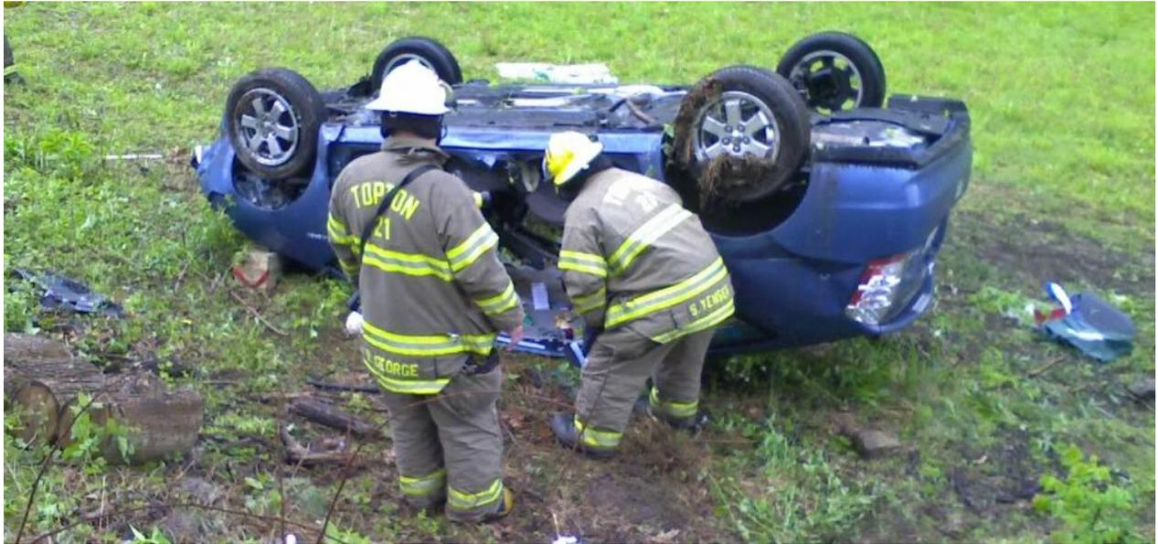
**Abbildung 51:** Dieser Toyota Prius war in einen Fahrzeugüberschlag verwickelt. Dabei wurden keine Airbags ausgelöst. Rettungskräfte müssen derartige Fahrzeuge deshalb manuell deaktivieren. Es ist von großer Bedeutung die Zündung des Fahrzeugs auszuschalten und das 12/24 Bordnetz zu unterbrechen. In diesem Fall befindet sich die 12 Volt Batterie im Kofferraum und ist leicht zugänglich. (Foto: Tipton Volunteer Fire Company)
