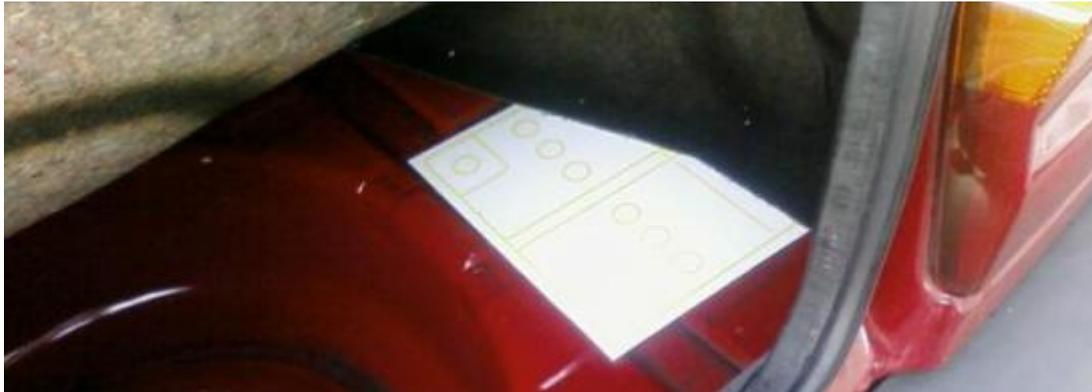
**Abbildung 68: Batterie-Dummy im Kofferraum des Fahrzeugs**
