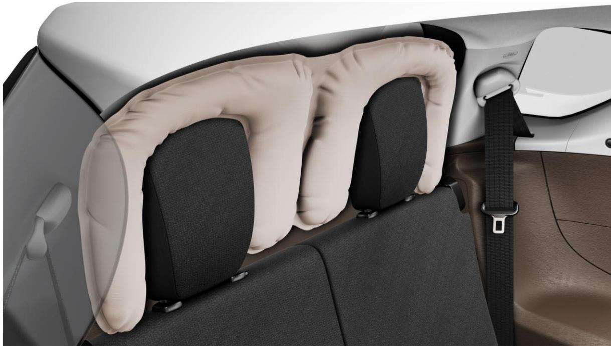
**Abbildung 19: Heckairbag bei einem Toyota/Scion iQ. (Grafik: Toyota)**
