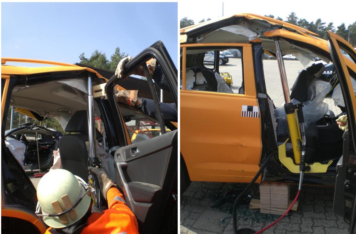
**Abbildung 33:** Ein Teleskopzylinder wird hier zum Abreißen des Daches von der B-Säule verwendet. Der erste Einsatz erfolgt hinter der B-Säule. Der Holzkeil dient zum Schutz der Kolbenstange des Zylinders vor scharfen Kanten. Nach dem Umsetzen des Zylinders vor die Säule konnte das Dach komplett abgerissen werden. Ein Schwelleraufsatz kommt zum Einsatz um das Einbrechen des Zylinders in den Schweller zu verhindern, außerdem wurde die B-Säule entsprechend unterbaut.
