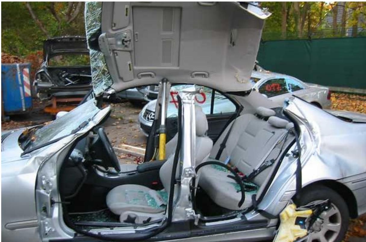
**Abbildung 37:** Das Dach dieser Mercedes-Benz C-Klasse wurde nicht abschnitten sondern lediglich zur Seite gedrückt. Diese Technik funktioniert am besten bei Fahrzeugen mit drei Säulen, da das Dach beim Wegdrücken der mittleren Säule dann nach oben gedrückt wird.
