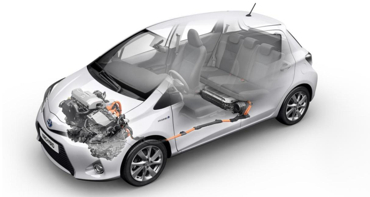
**Abbildung 47:** Die Abbildung dieses Toyota Yaris Hybrid zeigt deutlich die Einbauorte der Komponenten der Hochvoltanlage. Die Hochvoltbatterie befindet sich unter dem Rücksitz. Orangefarbene Hochvoltkabel verlaufen am Fahrzeugboden zum Motorraum, wo sie mit dem Elektromotor und anderen Komponenten verbunden sind. (Grafik: Toyota).
