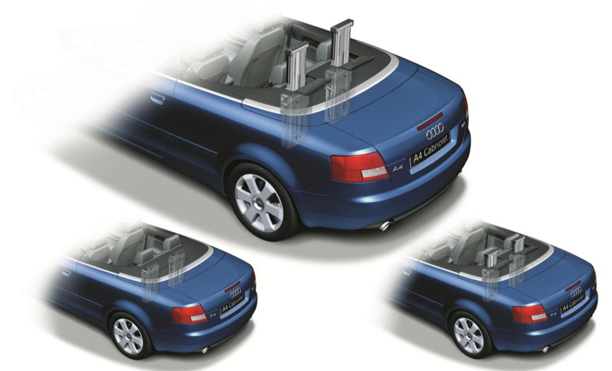
**Abbildung 44: Automatischer Überrollbügel bei einem Audi A4 Cabriolet. Die beiden automatischen Überrollbügel springen hinter dem linken und rechten Sitz nach oben wenn ein Überschlag erkannt wird. (Grafik: Audi)**
