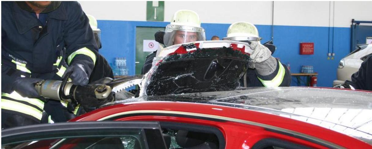
**Abbildung 36:** In diesem Fall wurde ein hydraulisches Schneidgerät eingesetzt um den Heckscheibenausschnitt zu erweitern. Hierzu wurden links und rechts Schnitte in die Dachkante gesetzt und die Dachkante anschließend wie ein Spoiler nach oben gebogen. Hierdurch wird ggf. bereits genug Platz gewonnen, dass der Insasse durch die Heckscheibe befreit werden kann.
