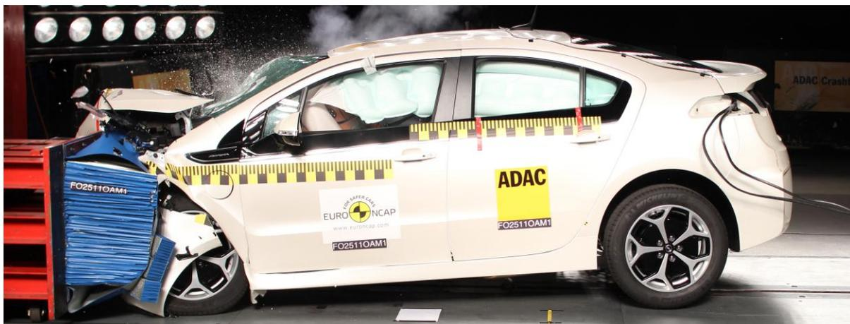
**Abbildung 46: Frontal-Offset Crashtest mit einem Opel Ampera. Der Test zeigt das hohe Sicherheitsniveau, alle Sicherheitsfunktionen arbeiteten wie geplant. Das Antriebssystem wurde bei Unfallerkennung abgeschaltet (Abschalten); die Hochvoltbatterie wurde nicht beschädigt. (Foto: EuroNCAP)**
