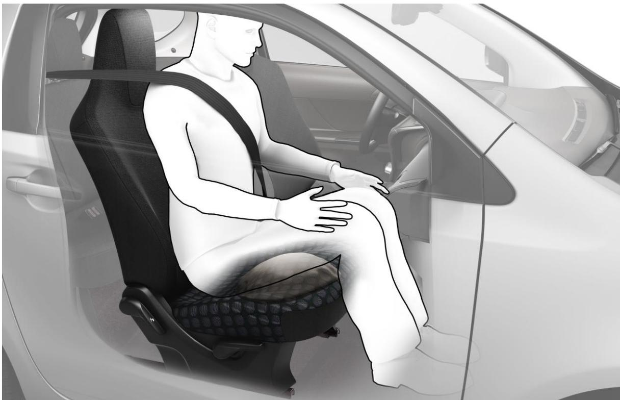
**Abbildung 10:** Dieser Toyota/Scion iQ verfügt über einen Anti-Submarining Airbag im Beifahrersitz. Der Airbag hebt die Front der Sitzfläche an um das hindurchtauchen des Insassen unter dem Beckengurt zu verhindern. (Grafik: Toyota)
