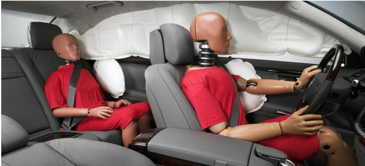
**Abbildung 13: Das Foto zeigt sitzseitig montierte Seitenairbags für vordere und hintere Sitzreihe sowie den durchgehenden Kopfairbag, der sich aus der Dachkante heraus entfaltet. (Foto: Daimler)**
