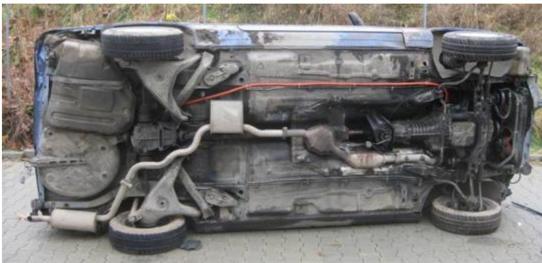
**Abbildung 69: Nachträglich angebrachtes Hochvoltkabel am Fahrzeugboden**
