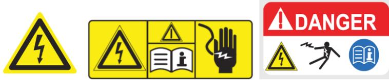
Abbildung 48: Beispiele für Warnaufkleber an Hochvoltkomponenten.
