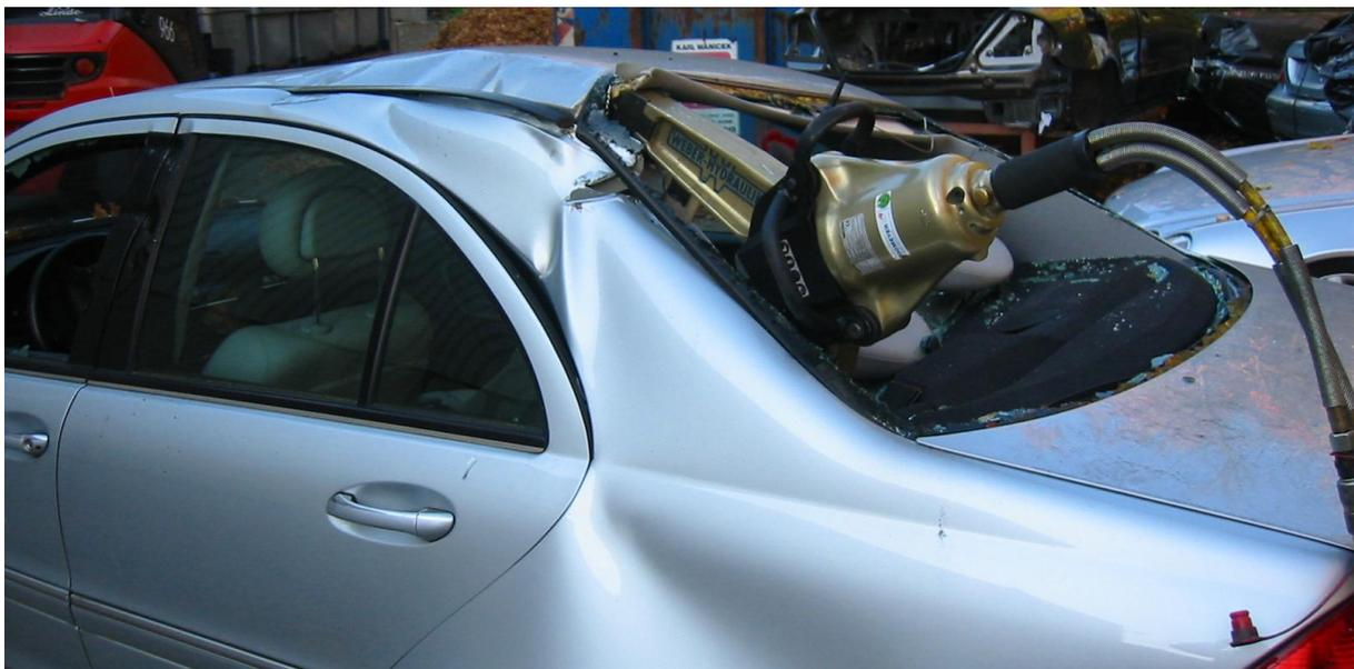
**Abbildung 31:** Die Abbildung zeigt beispielhafte eine Methode um schnell einen Rettungsweg durch die Heckscheibe herzustellen. Anstelle einer totalen oder partiellen Dachentfernung kann der Heckscheibenausschnitt mit dem Spreizer erweitert werden, entweder indem das Dach nach oben oder die Hutablage nach unten gedrückt wird.
