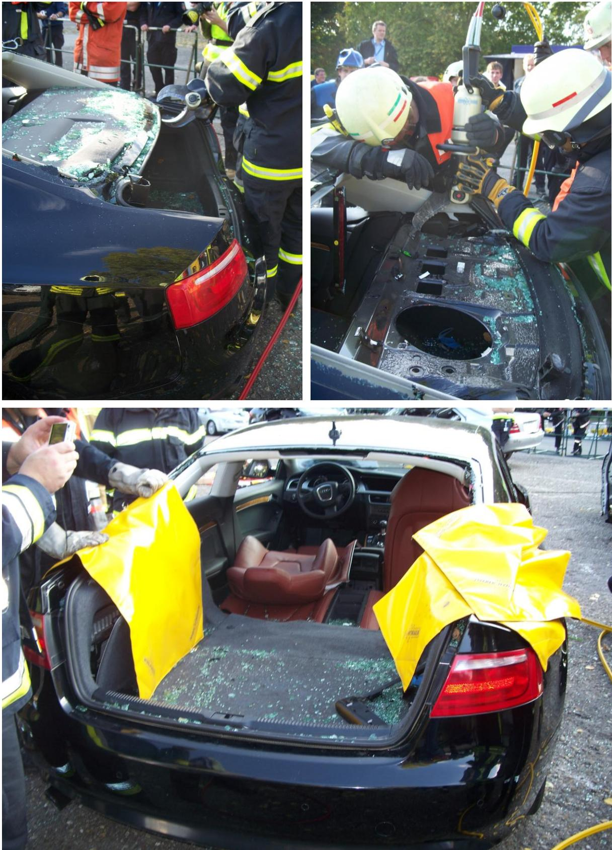
**Abbildung 39: Tunneln durch den Kofferraum bei einem Audi S5. Der Kofferraumdeckel wurde mit dem Schneidgerät entfernt und die Hutablage mit Säbelsäge und Schneidgerät herausgetrennt. Anschließend wurde der Rücksitz auf dem Fahrzeug entfernt.**
