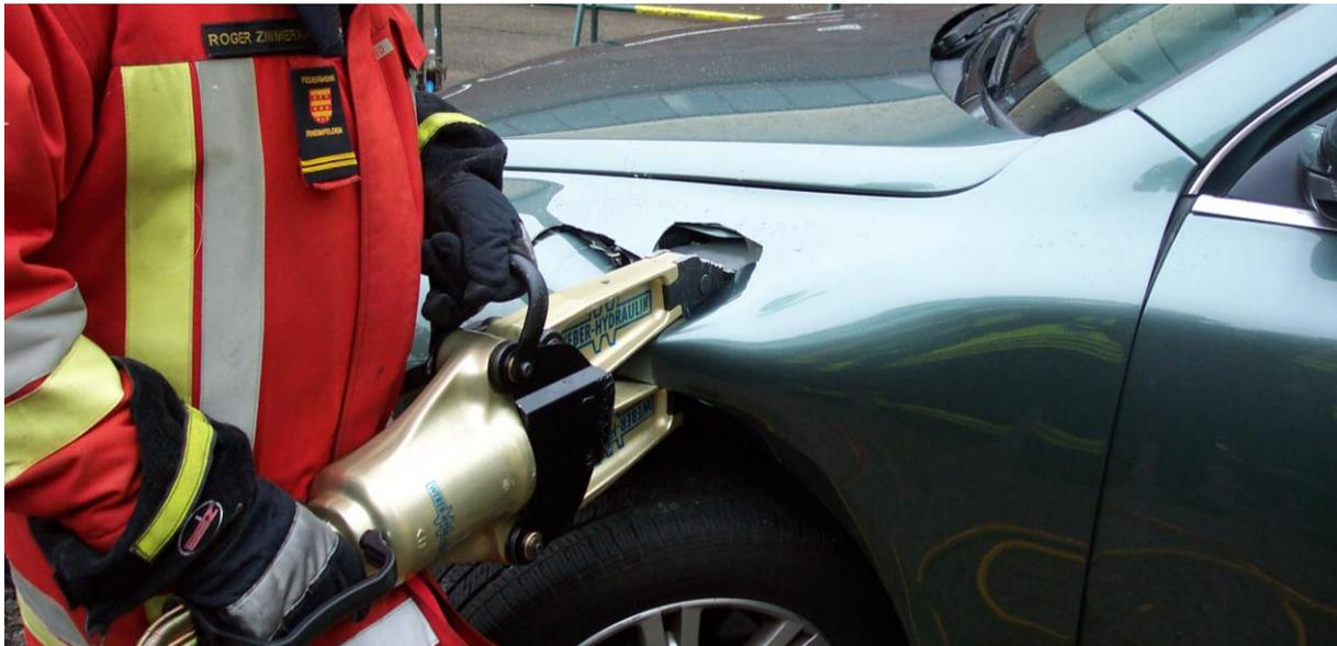
**Abbildung 30:** Der vordere Kotflügel dieses Volkswagen Touareg besteht aus Kunststoff. Das Quetschen bringt nicht den gewünschten Effekt Zugang zu den Scharnieren zu erlangen. Der Geräteführer muss flexibel sein und auf Plan B umschalten um mit einer anderen Technik das Ziel zu erreichen.
