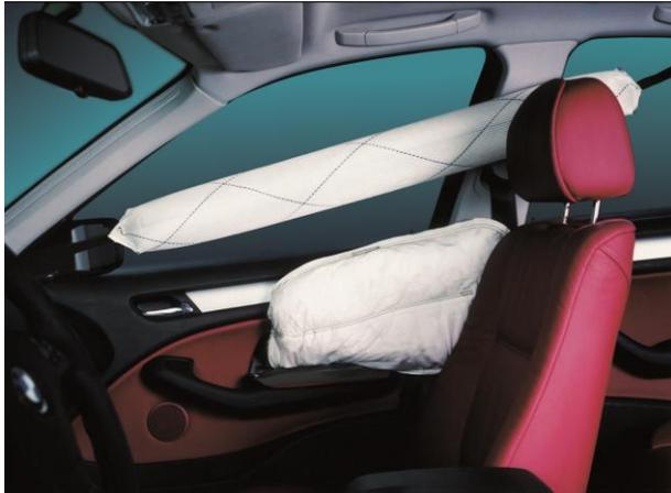
**Abbildung 15: Türseitig montierter Seitenairbag kombiniert mit einem ITS (Inflatable Tubular Structure) Kopfairbag. (Foto: BMW)**
