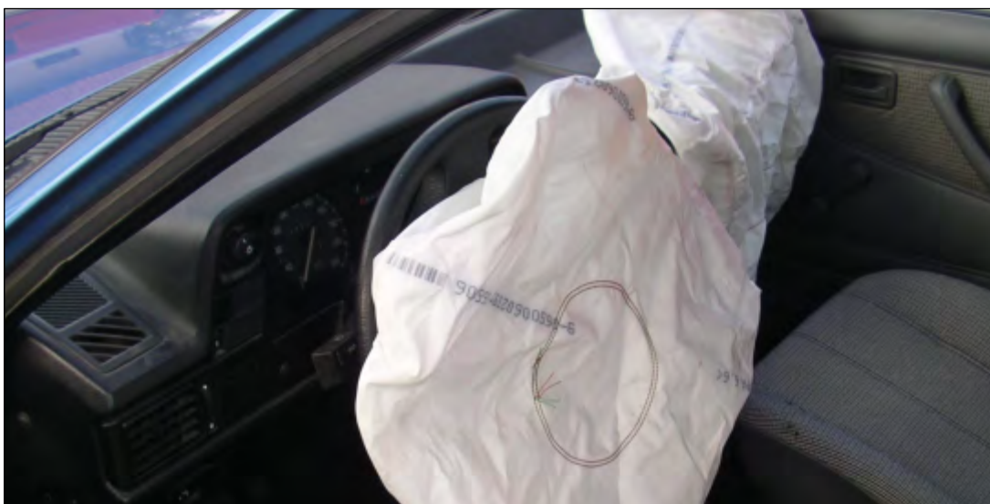
Afbeelding 37: Naderhand aangebrachte airbags voor bestuurder en passagier
