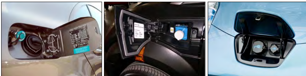
Afbeelding 25: Verschillende tankdoppen, a. bivalent benzine-/aardgas, b. elektrische auto, laadstekker in het spatbord, c. elektrische auto met 2 laadstekkers aan de voorzijde.
