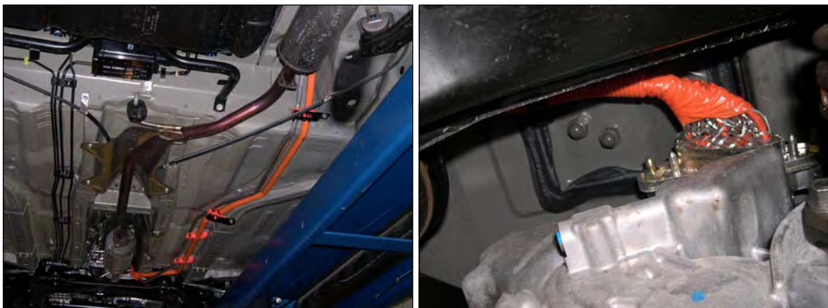
Afbeelding 16: Hoogspanningsleidingen onder de bodemplaat van hybride auto's (Honda Civic IMA, Lexus RX 400h). In de rechter afbeelding is de draadgevlochten isolatie te herkennen.
