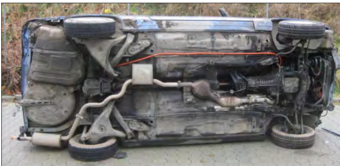
Afbeelding 39: Naderhand aangebrachte hoogspanningskabel onder de bodemplaat
