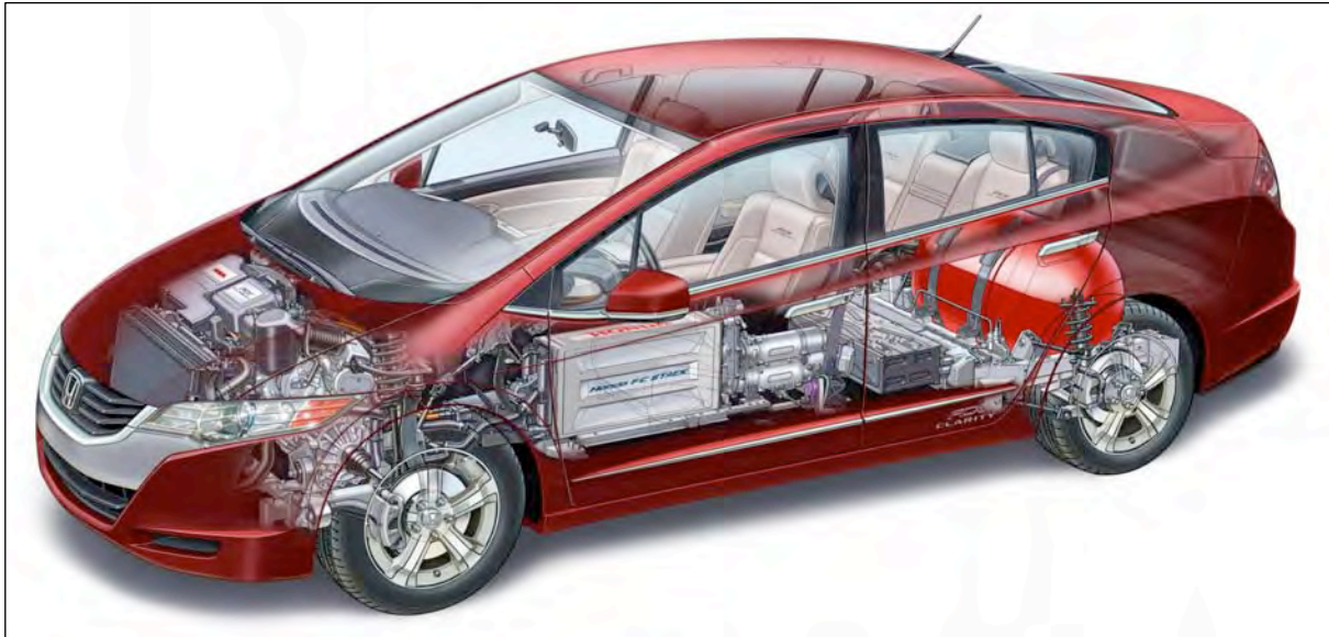
Afbeelding 19: Honda FCX Clarity testauto met waterstofaandrijving. Bij deze auto wordt waterstof onder hoge druk (345 bar) opgeslagen en vervolgens toegevoerd aan een brandstofcel. Deze genereert vervolgens stroom voor de elektromotor. Tevens is een hoogspanningsaccu ingebouwd (Bron: Honda).
