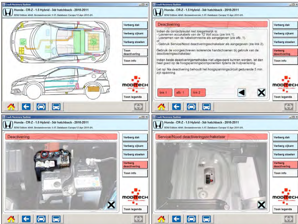
Afbeelding 32: Wanneer de “Start/Stop”-knop van deze Honda CR-Z (milde hybride) niet toegankelijk is dan dient ter deactivering van het aandrijfsysteem een extra kabelverbinding te worden doorgeknipt of de Service-/noodchakelaar bediend te worden.
