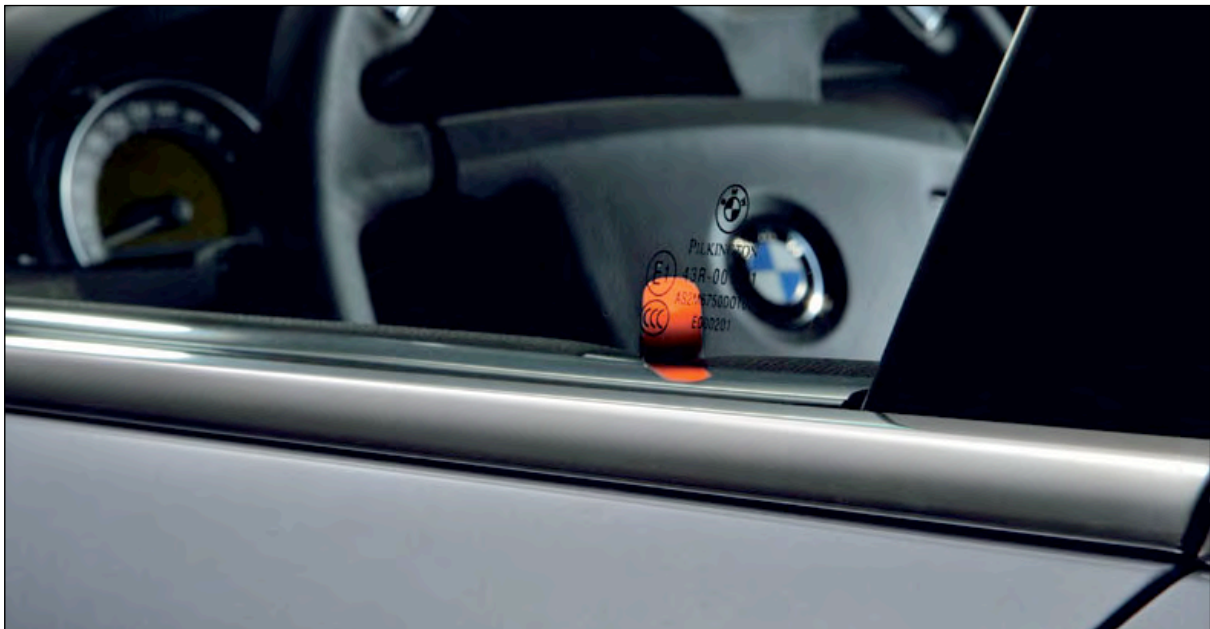
Afbeelding 27: Gasalarmsysteem van de BMW Hydrogen7. De LEDs van het systeem zijn geïntegreerd in de slotpen van de deur en lichten op in het geval van een gasalarm (Bron: BMW).
