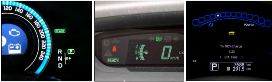
Afbeelding 29: Voorbeelden van “Ready-indicatoren” bij diverse hybride- en elektrische auto’s.
