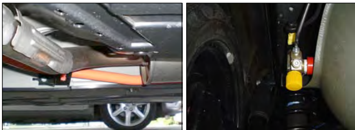
Afbeelding 23: Blik onder de auto, a. Hoogspanningsleiding, b. Gastank
