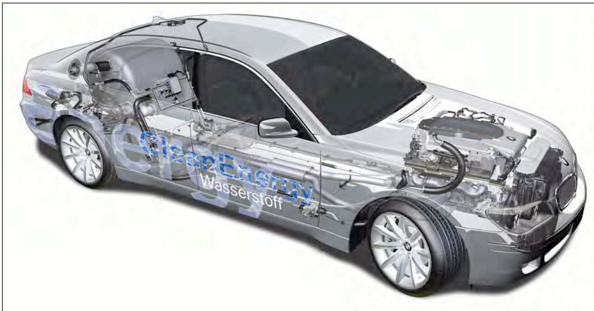
Afbeelding 18: BMW Hydrogen7 testauto met waterstofaandrijving. Bij deze auto wordt waterstof bij -253 °C vloeibaar opgeslagen en vervolgens in de verbrandingsmotor verbrand (Grafik: BMW).
