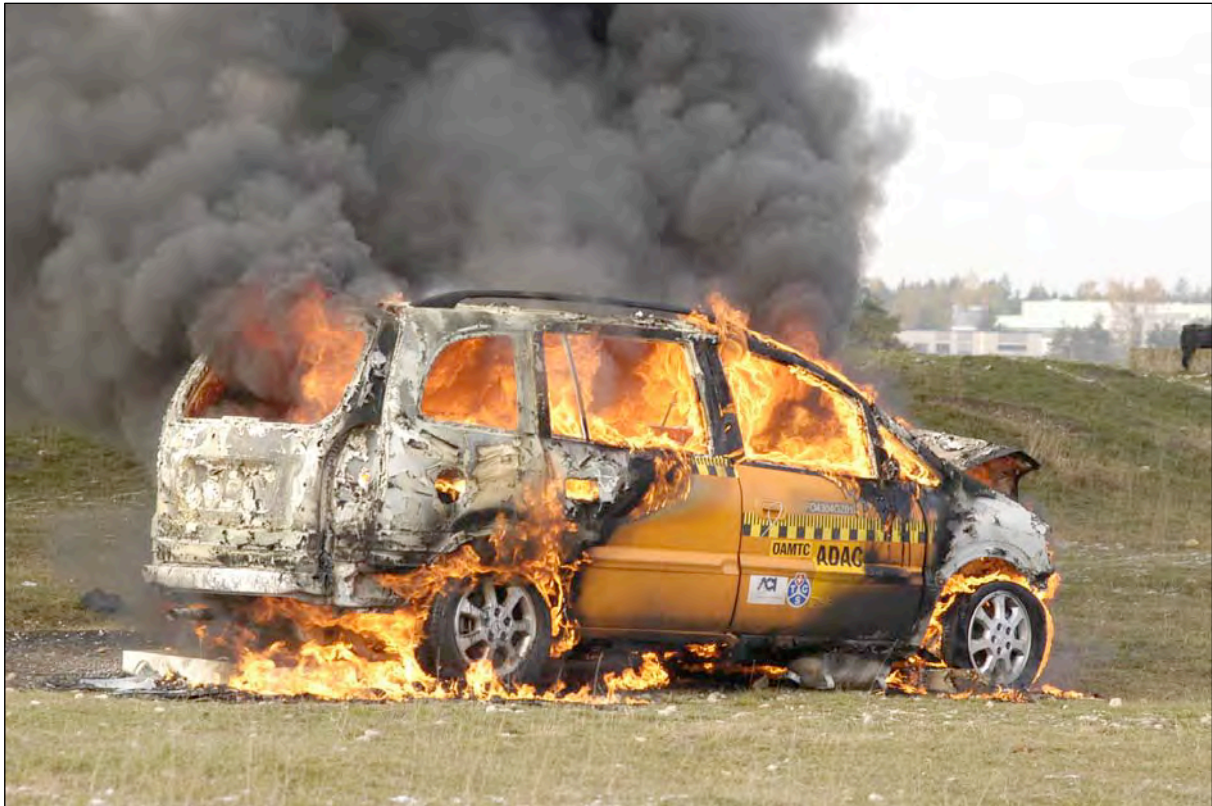
Afbeelding 6: Brandtest van een auto op aardgas. Om ontploffen van de aardgastank te vermijden, zorgt de geactiveerde thermische beveiliging voor een gecontroleerd afblazen van het aardgas zodra de temperatuur sterk toeneemt (Foto: ADAC).
