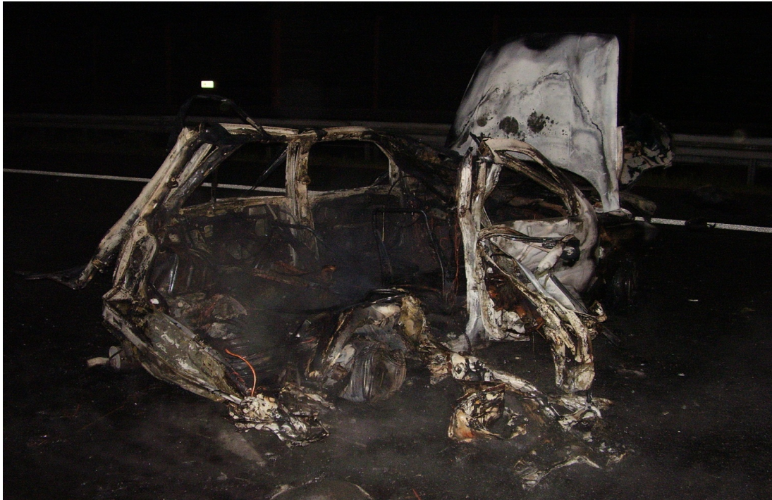
Afbeelding: Totaal verwoeste auto na exploderen gastank
