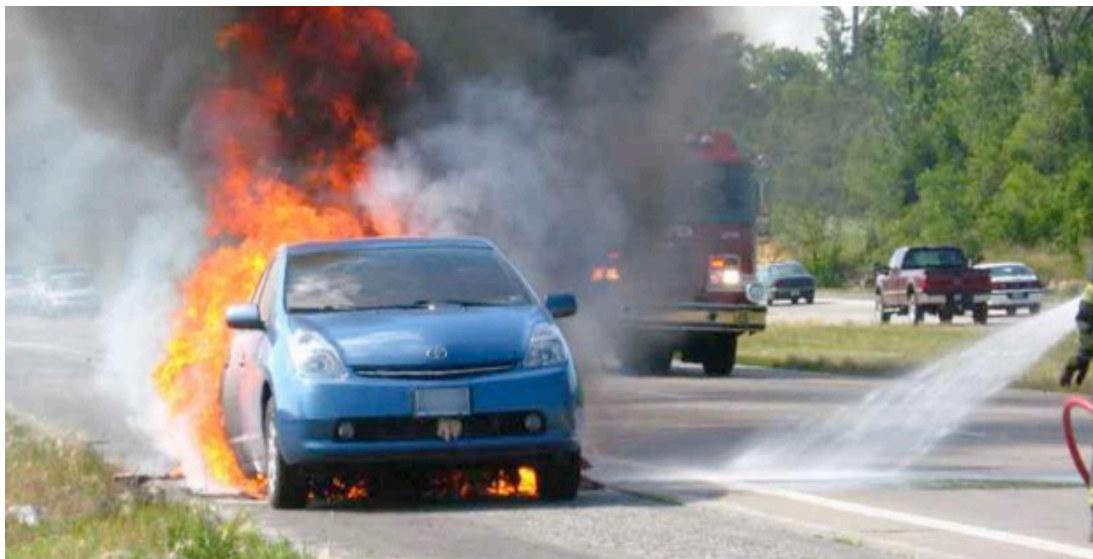
Afbeelding: Toyota Prius in de brand. Gezien de positie van het accupakket is deze zeer waarschijnlijk al betrokken bij de brand
