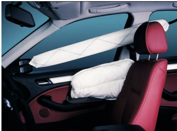
Figuur 15: Zij-airbag gemonteerd in de deur, gecombineerd met een ITS (Inflatable Tubular Structure) Hoofd-airbag. (afbeelding: BMW)
