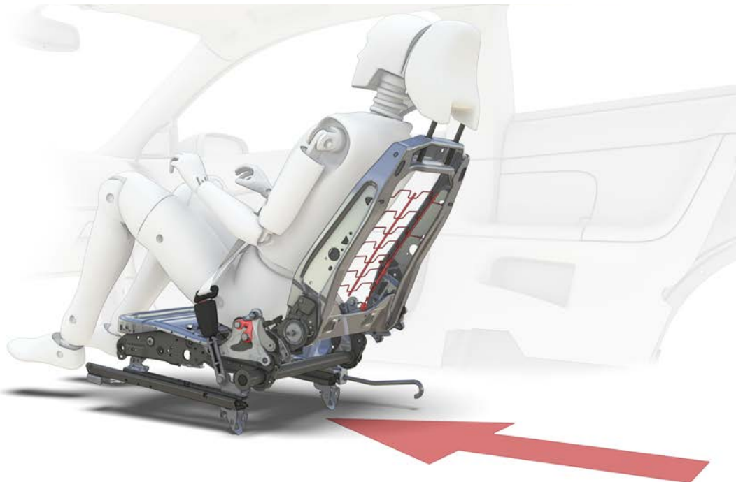
Figuur 18: Stoelen van moderne Volvo's zijn uitgerust met het WHIPS (Whiplash Protection System). Bij dit systeem beweegt de complete stoelleuning samen met de inzittende tijdens een achteraanrijding. Hiervoor is de stoel uitgevoerd met een metalen gedeelte wat tijdens het ongeval verbuigt en zo energie absorbeert. (afbeelding: Volvo).
