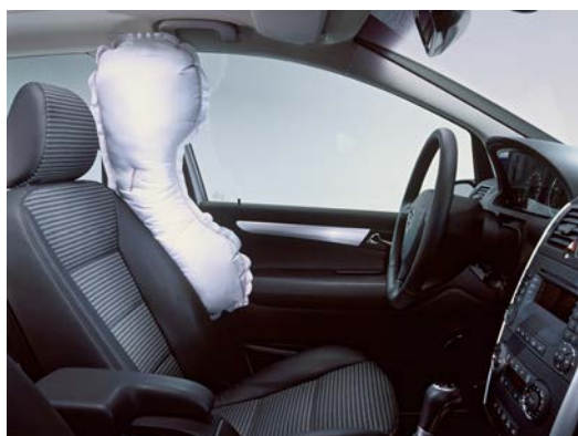
Figuur 14: Zij-airbag gemonteerd in de stoel welke tevens naar boven uitvouwt ter bescherming van het hoofd van de inzittende. (afbeelding: Daimler)
