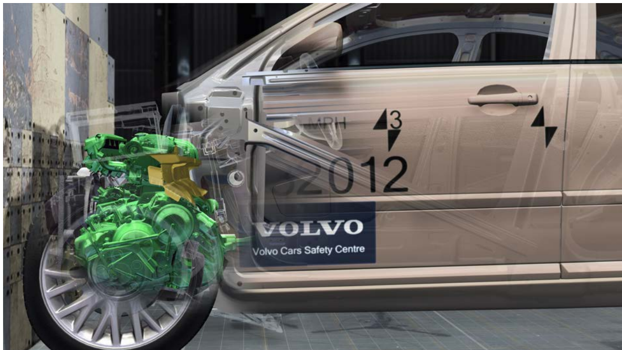
Figuur 4: Een dwarsbalk welke beide A-stijlen verbindt, houdt de motor buiten de veiligheidskooi. (afbeelding: Volvo)
