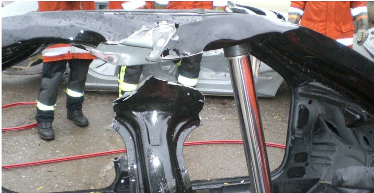
Figuur 32: De B-stijl van deze Mercedes-Benz S-Klasse is met een hydraulische cilinder afgescheurd. De cilinder werd tussen de dorpel en dakrand geplaatst en vervolgens uitbewogen. Het dak kon zo compleet van de B-stijl afgescheurd worden.
