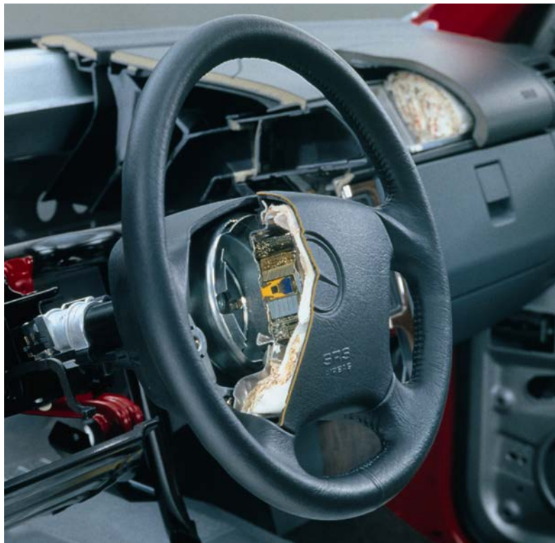
Figuur 40: Doorsnede van een bestuurdersairbag. De pyrotechnische gasgenerator is zichtbaar in het midden van het stuurwiel. Na ontsteking ontbrandt de pyrotechnische lading en ontwikkelt een grote hoeveelheid stikstof om de airbag te vullen. De airbag drukt de afdekkap weg en ontvouwt zich. (afbeelding: Daimler)
