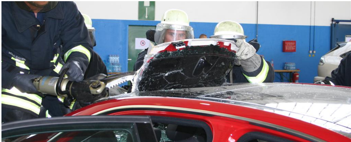
Figuur 36: In dit geval werd hydraulisch snijgereedschap ingezet om de achterraamopening te vergroten. Hiervoor werd de dakrand links en rechts ingeknipt en de dakplaat vervolgens als een spoiler omhoog gebogen. Hierdoor werd genoeg ruimte gewonnen om de inzittende door de achterraam opening af te voeren.
