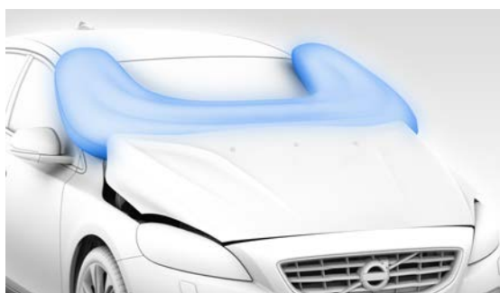
Figuur 22: Voetgangers-airbag bij een Volvo V40. Wanneer een aanrijding met een voetganger gedetecteerd wordt, worden de scharnieren van de motorkap door twee kleine pyrotechnische ladingen vrijgegeven. De voetgangers-airbag vouwt zich uit en tilt de motorkap gelijktijdig ca. 10 cm op. Door de airbag wordt de kans op letsel door impact met harde delen zoals de A-stijl en de voorruit verkleind. (afbeelding: Volvo)
