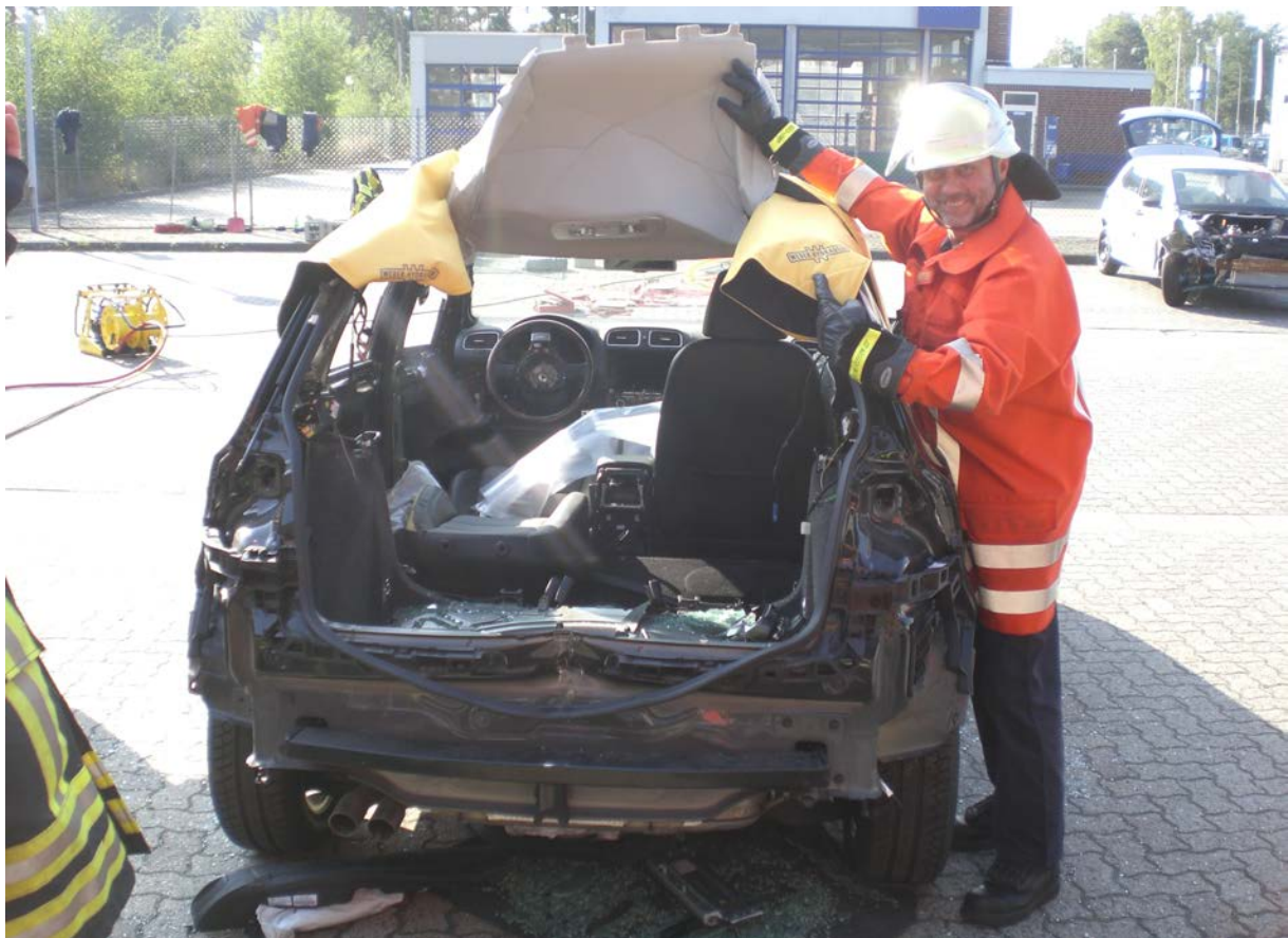
Figuur 38: Het plaatstaal van het dak van deze Volkswagen Golf is aan beide zijden met een reciprozaag doorgeknipt. Aansluitend kon het dak tezamen met de hemelbekleding naar voren geklapt worden. Hierdoor is genoeg ruimte ontstaan om de inzittenden via de achterkant af te voeren.
