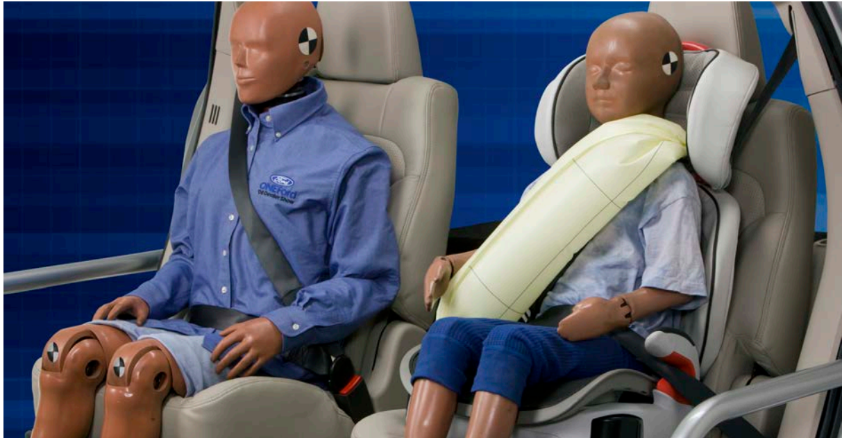
Figuur 11: Oplblaasbare gordel (gordel-airbag) getoond voor inzittenden op de achterbank. De opblaasbare gordel verdeelt de krachten beter over het lichaam van de inzittende. (afbeelding: Ford)
