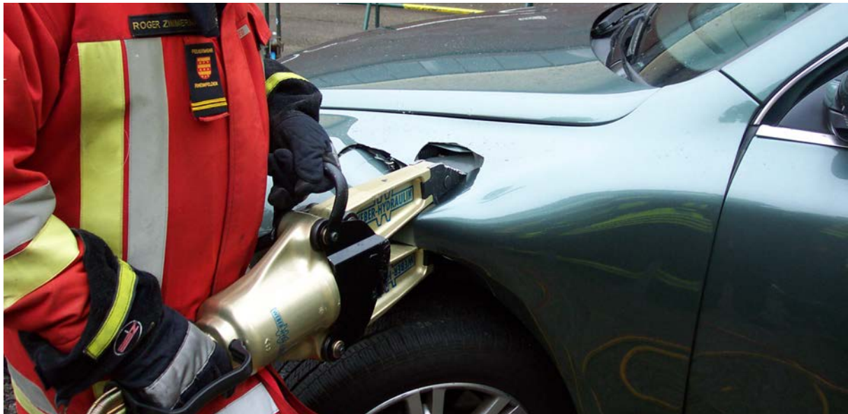
Figuur 30: Het voorspatbord van deze Volkswagen Touareg is gemaakt van plastic. Samendrukken van het spatbord is geen succesvolle methode om toegang te verkrijgen tot de scharnieren. De operator dient flexibel genoeg te zijn om naar plan B over te schakelen en een andere methode toe te passen om het doel alsnog te bereiken.
