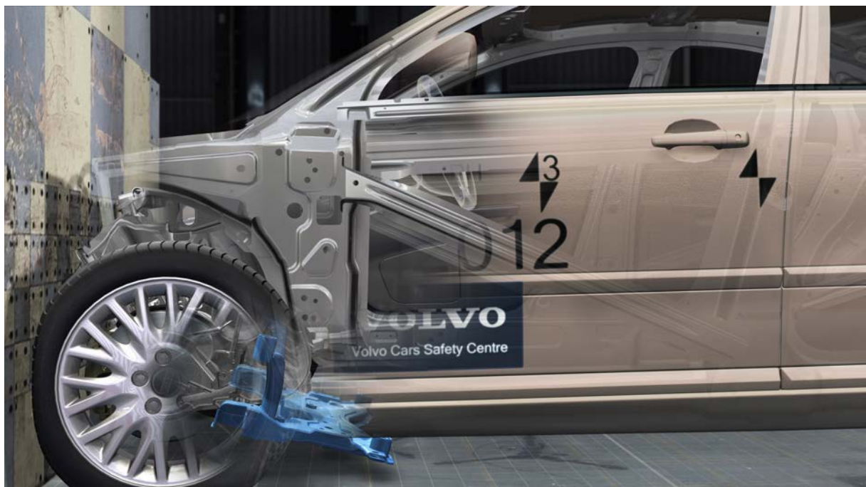
Figuur 5: De wielen worden tegen de A-stijl gedrukt en worden ondersteund zodat de vorm van de bodem ter hoogte van de pedalen in tact blijft. (afbeelding: Volvo)
