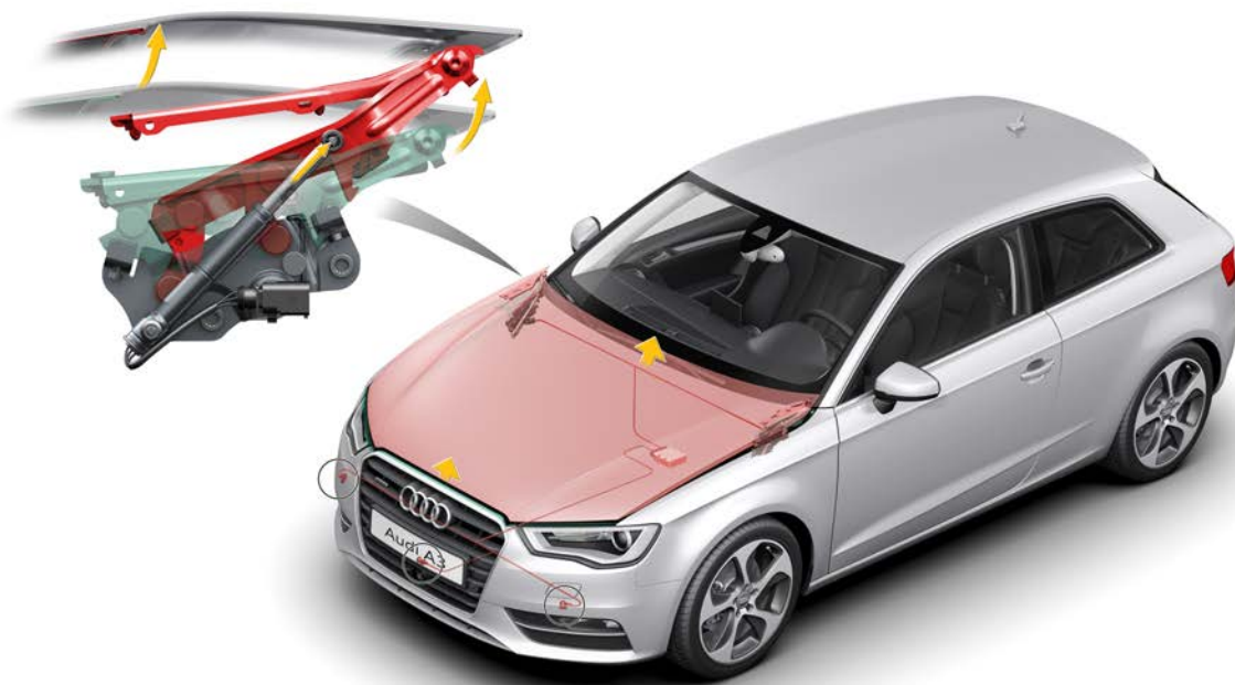
Figuur 21: Voetgangerbeschermingssysteem, hier bij een Audi A3. Sensoren in de voorbumper zijn in staat een aanrijding met een voetganger te detecteren en activeren twee pyrotechnisch bewogen zuigers welke het achterste deel van de motorkap omhoog bewegen. Hierdoor ontstaat meer ruimte tussen de motorkap en de motordelen. (afbeelding: Audi)
