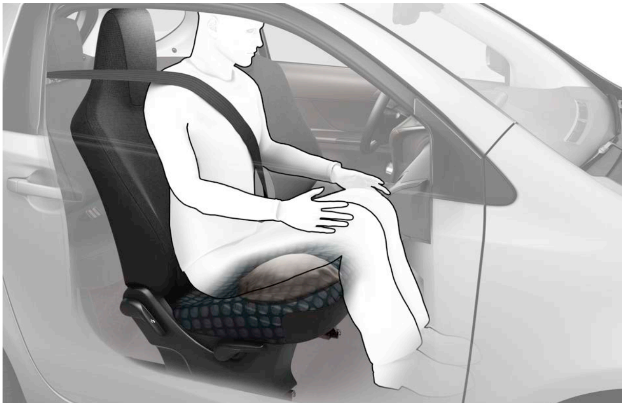
Figuur 10: Deze Toyota/Scion iQ beschikt over een anti-submarining airbag in de passagiersstoel. De airbag drukt de voorzijde van de stoel omhoog ter voorkoming van het “submarining” effect. (afbeelding: Toyota)
