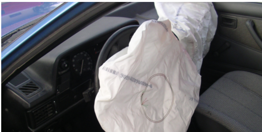
Figuur58: Gesimuleerde geactiveerde bestuurder- en passagiersairbags
