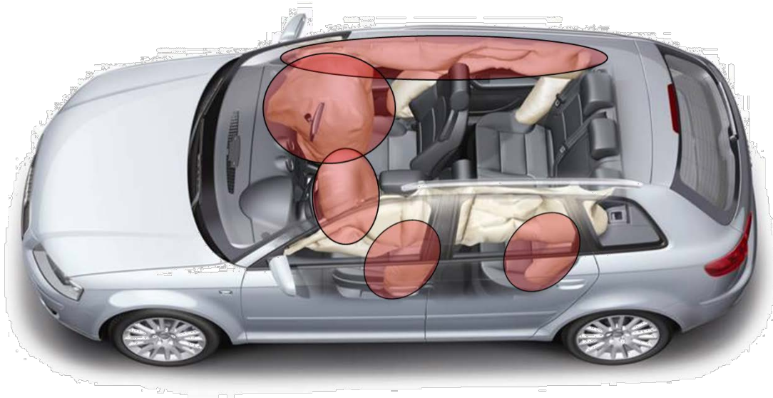
Figuur 55: Deze afbeelding toont de noodzakelijke veiligheidsafstanden van airbags. Hulpverleners dienen minimaal 30 cm afstand te houden tot zij- en gordijnairbags, 60 cm tot de bestuurdersairbag en 90 cm tot de passagiersairbag gedurende alle werkzaamheden. (afbeelding: Audi)
