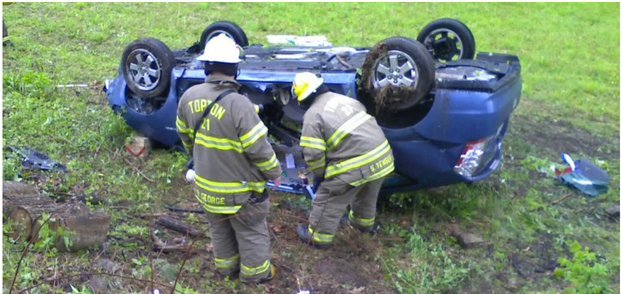
Figuur 50: Deze Toyota Prius is over de kop geslagen. Er zijn geen airbags geactiveerd. Hulpverleners dienen de voertuigen in dit soort situaties handmatig te deactiveren. Het is in dit soort gevallen zeer belangrijk het contact uit te zetten en het 12/24 Volt circuit te onderbreken. In dit geval bevindt de 12/24 Volt accu zich in de kofferruimte en is daarom goed toegankelijk. (afbeelding: Topton Volunteer Fire Company)
