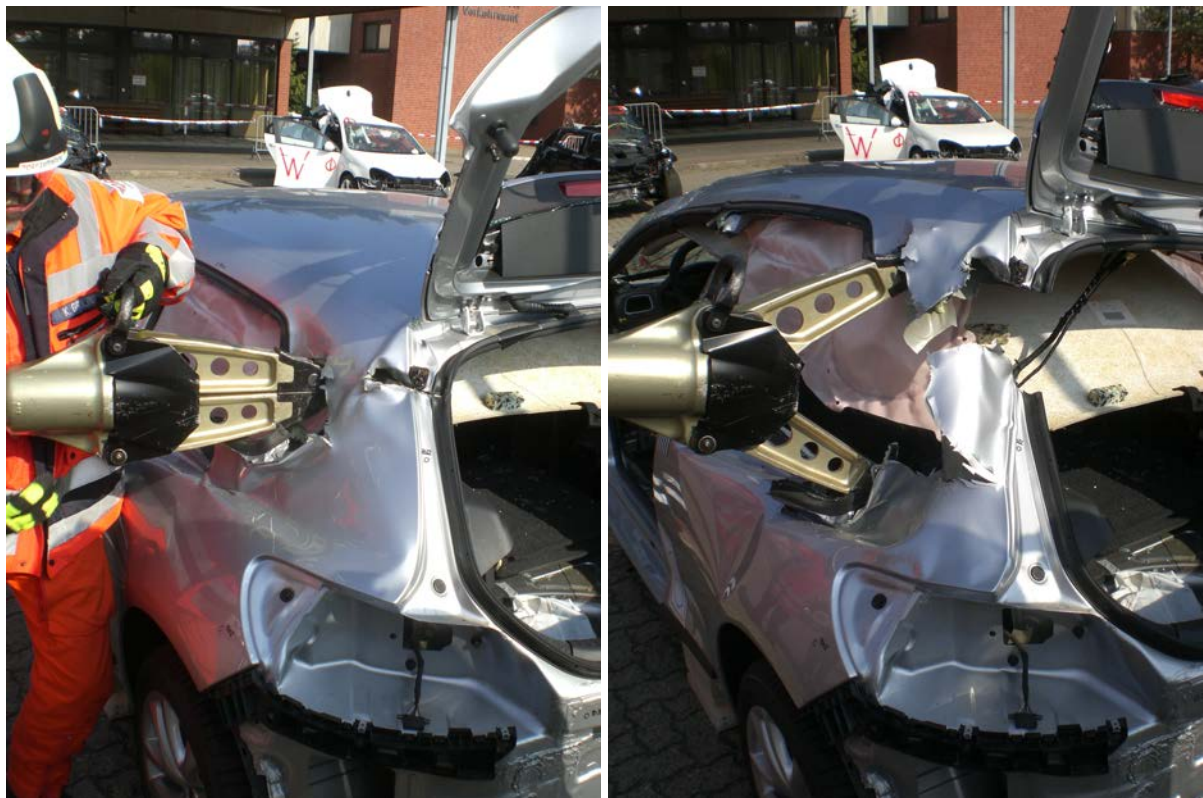
Figuur 34: De spreider wordt bij deze Volkswagen Sirocco gebruikt om de C-stijl af te scheuren. Aanvankelijk heeft de operator zonder succes geprobeerd de C-stijl door inknippen van links en rechts door te knippen. In plaats van te proberen het moeilijk toegankelijke midden van de inkeping te bereiken is vervolgens de spreider ingezet om de C-stijl door midden te scheuren.
