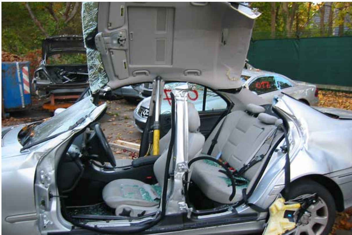
Figuur 37: Het dak van deze Mercedes-Benz C-Klasse werd niet verwijderd maar uit de weg gedrukt. Deze techniek functioneert het beste bij voertuigen met drie stijlen, omdat het dak tijdens het wegdrukken van de middelste stijl dan naar boven gedrukt wordt.
