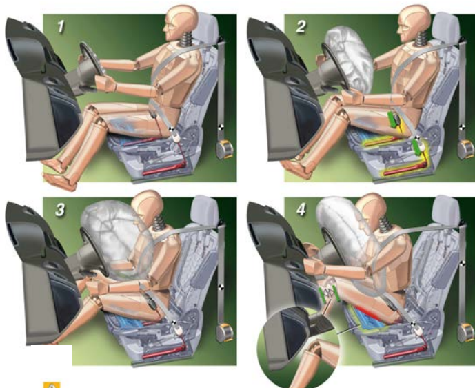
Figuur 7: De gordel is het belangrijkste veiligheidssysteem. Gordelspanners worden gebruikt om de gordel aan te spannen. Airbags vullen dit aan door een kussen te vormen voor delen als het stuurwiel en voorkomen daarmee directe impact. (afbeelding: Renault)
