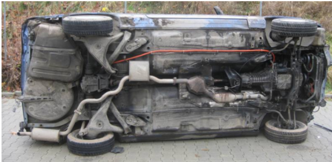
Figuur60: Naderhand aangebrachte hoogspanningskabel onder de bodemplaat
