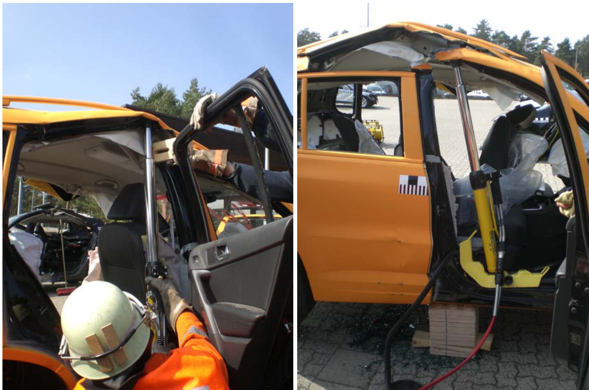
Figuur 33: Een telescoopcilinder wordt hier toegepast om het dak van de B-stijl van deze Volkswagen Tiguan af te scheuren. De eerste inzet vindt direct achter de B-stijl plaats. Het houtblok dient ter bescherming van de zuigerstang tegen scherpe randen. Na herpositioneren van de cilinder naar de voorkant van de stijl kon het dak compleet afgescheurd worden. Let op de dorpelsteun en ondersteuning onder de dorpel om indringing van de cilinder in de dorpel te voorkomen.
