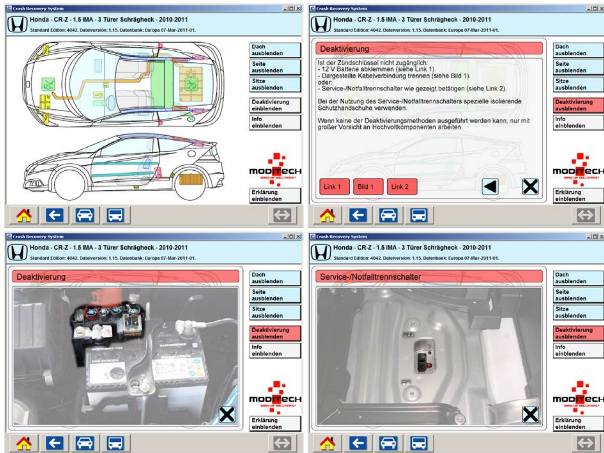
Figuur 6: Als de contactsleutel van deze Honda CR-Z (milde hybrid) niet toegankelijk is, dient een kabelverbinding verwijderd te worden, of de Nood/Service schakelaar dient bediend te worden om alle voertuigsystemen te deactiveren.
