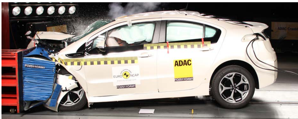
Figuur 45: Crash test met frontale offset met een Opel Ampera. De test toont het hoge veiligheidsniveau aan, alle veiligheidssystemen functioneerden als gepland. Het aandrijfsysteem werd na herkenning van het ongeval uitgeschakeld (Uitschakelen); de hoogvoltage accu werd niet beschadigd. (afbeelding: EuroNCAP)
