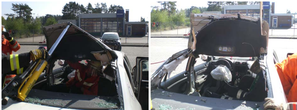
Figuur 35: Het achterste gedeelte van het dak kon in dit geval met een hydraulische cylinder omhoogbewogen cq. naar voren geklapt worden. Hiervoor kan het aanvankelijk nodig zijn achterste deel van het dak links en rechts in te knippen om startpunten voor het afscheuren te definiëren. In dit geval is de dakplaat ter plaatse van de puntlassen aan de dakrand afgescheurd.
