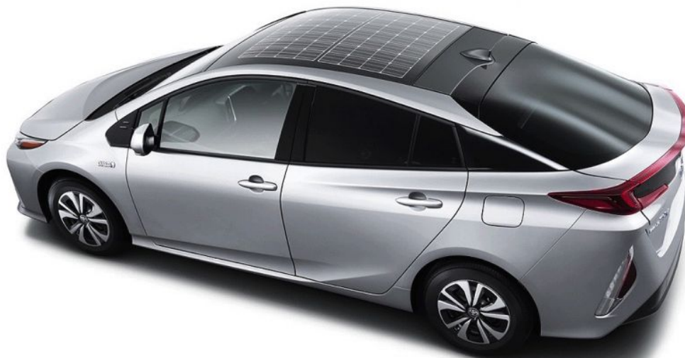
Afbeelding: Toyota Prius Plug-Hybrid 2018 met zonnepaneel
