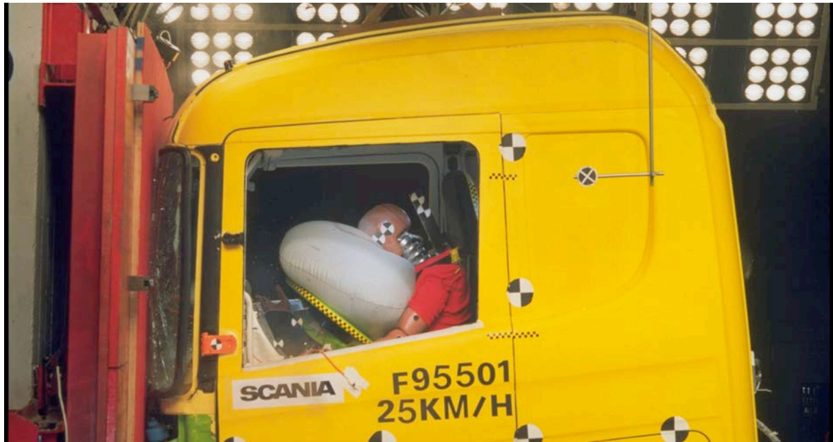
Afbeelding 17: ook bij vrachtwagens geldt dat de veiligheidsgordel de levensredder nummer 1 is! De beschermende werking van de veiligheidsgordel kan eventueel worden uitgebreid met gordelspanners en een chauffeursairbag. (Foto: Scania)
