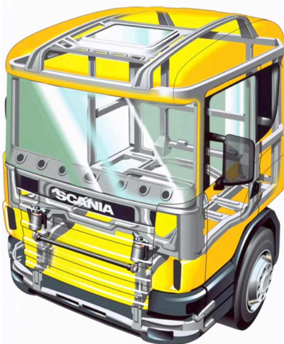
Afbeelding 6: constructie van de cabine van een vrachtwagenchauffeur. (Illustratie: Scania)
