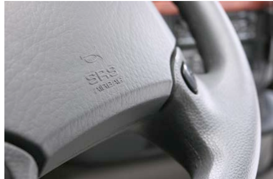
Afbeelding 16: chauffeursairbag met overeenkomstig opschrift bij een vrachtwagen (foto: Volvo Trucks)
