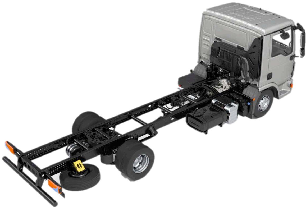
Afbeelding 2: het chassisframe vormt het draagwerk van de vrachtwagen waaraan alle andere componenten zoals assen, motor, chauffeurscabine, tanks etc. zijn gemonteerd. (Illustratie: MAN Nutzfahrzeuge)
