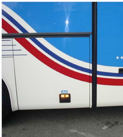
Afbeelding 23: bij deze bus bevindt zich de chauffeursruimte vóór de achterinstap. In de regel is deze van buitenaf en van binnenuit toegankelijk. (Foto: Rüdiger Knoll)
