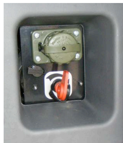
Afbeelding 26: accuhoofdschakelaar bij een touringcar.
