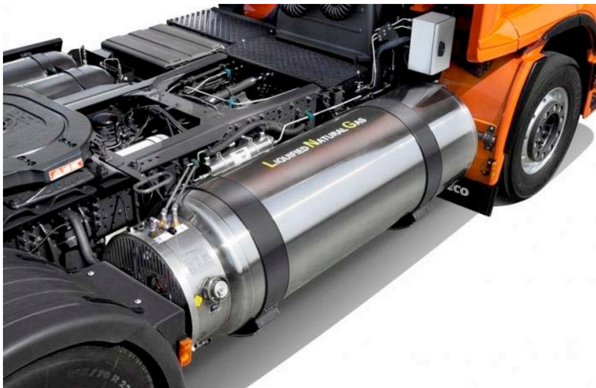
Afbeelding 28: vloeibaar aardgas (LNG) wordt in speciale tanks (zgn. cryogene tanks) bij -162\text{ °C} vervoerd. Het getoonde voertuig beschikt over een combinatie van CNG- en LNG-aandrijving. (Illustratie: Iveco)
