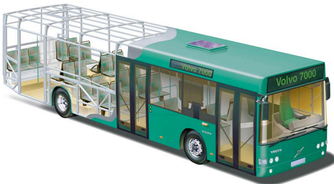
Afbeelding 18: skeletconstructie van een stadsbus. (Illustratie: Volvo Bus)
