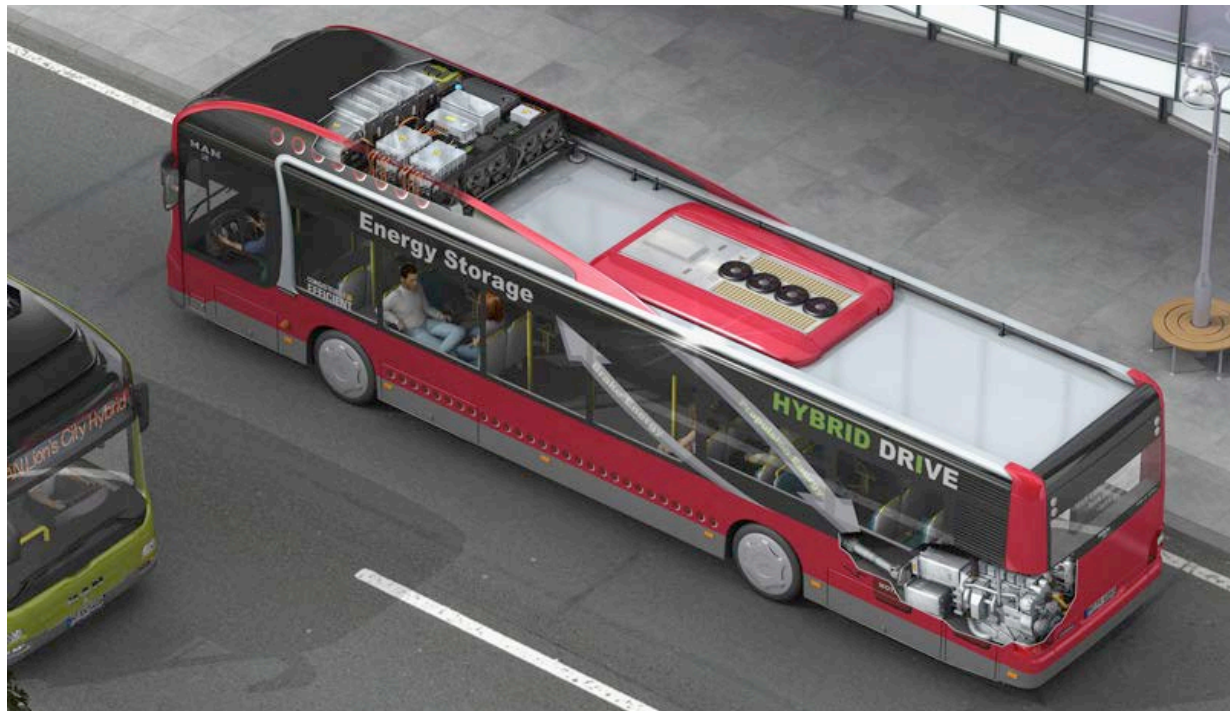
Afbeelding 31: MAN Lion's City Hybrid. De stadsbus wordt door twee elektromotoren aangedreven. De stroom wordt geleverd door een energiereservoir met ultracondensatoren, die op het voertuigdak is gemonteerd, of door een generator, die door een dieselmotor wordt aangedreven. (Illustratie: MAN Nutzfahrzeuge)
