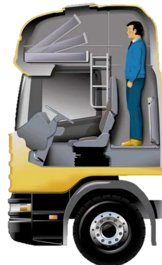
Afbeelding 11: vrachtwagens beschikken vaak over een bed/ligbank voor de inzittenden. (Illustratie: Scania)
