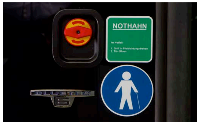
Afbeelding 21: noodbediening buiten bij de deur van een stadsbus. (Foto: Evobus GmbH)
