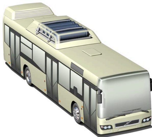
Afbeelding 27: bus met aardgasaandrijving (CNG). De drukgastanks zijn op het voertuigdak gemonteerd. (Illustratie: Volvo Bus)
