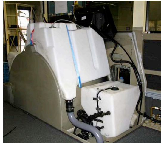
Afbeelding 20: de in de voorste passagiersstoelen geïntegreerde tank bij een stadsbus. (Foto: Evobus GmbH)
